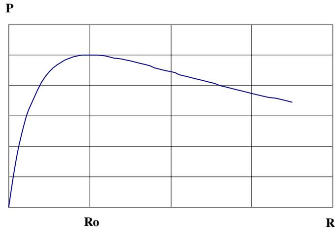
$$P_{\text{MAX}} = \frac{E_0^2}{4R_0} \text{ pour } R = R_0.$$
