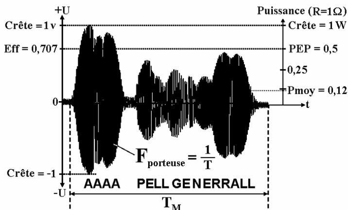
$$\text{Puissance instantanée} = P_i(t) = \frac{(U_{c\grave{a}c})^2}{8R} \begin{cases} \text{Puissance efficace} \\ \text{Signal sinusoïdal} \end{cases}$$
