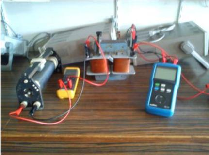
On connecte au circuit secondaire un rhéostat que l'on règle à une valeur de 25Ω. Pour effectuer des mesures, on ajoute un wattmètre en entrée du transformateur et un ampèremètre à sa sortie. On fait en sorte d'imposer une tension d'entrée de 30V.
