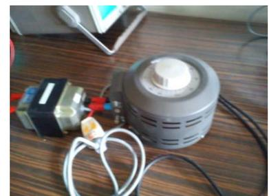
NB : Le transformateur d'isolement est limité en intensité. Son fusible l'empêche de dépasser 1 ampère.
