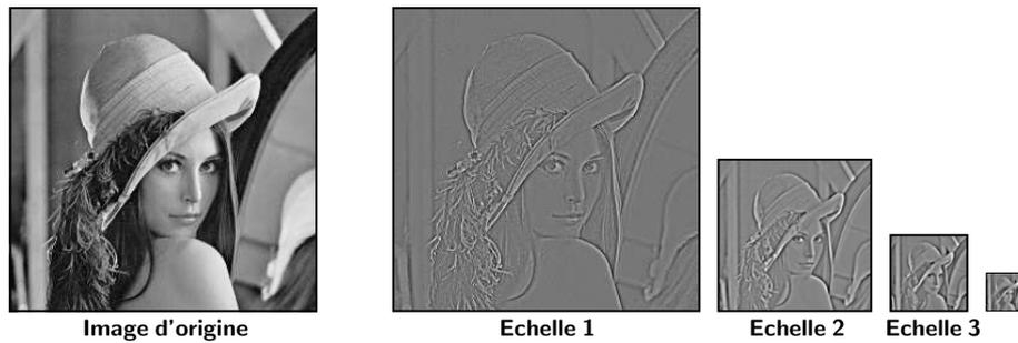
Fig. 6.17 *Transformée Laplacienne pyramidale.*
