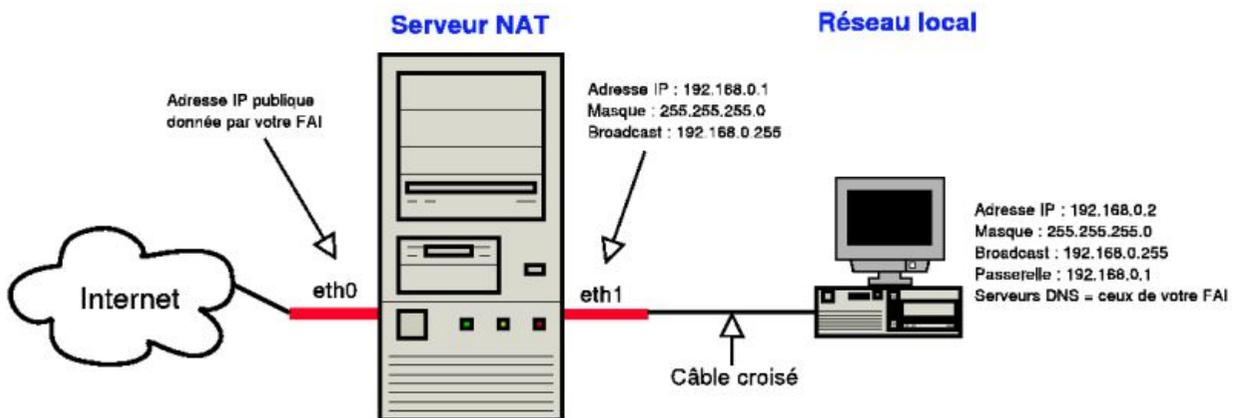
Figure N-2. Schéma d'un NAT avec plusieurs machines
