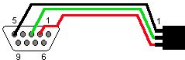
FIG. 12.8 – Brochage du câble série PC
