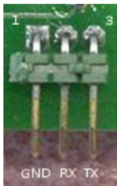
FIG. 12.7 – Brochage des connecteurs des ports USART0 et USART1
