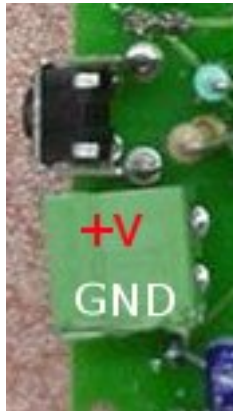
FIG. 12.6 – Brochage du connecteur d'alimentation
