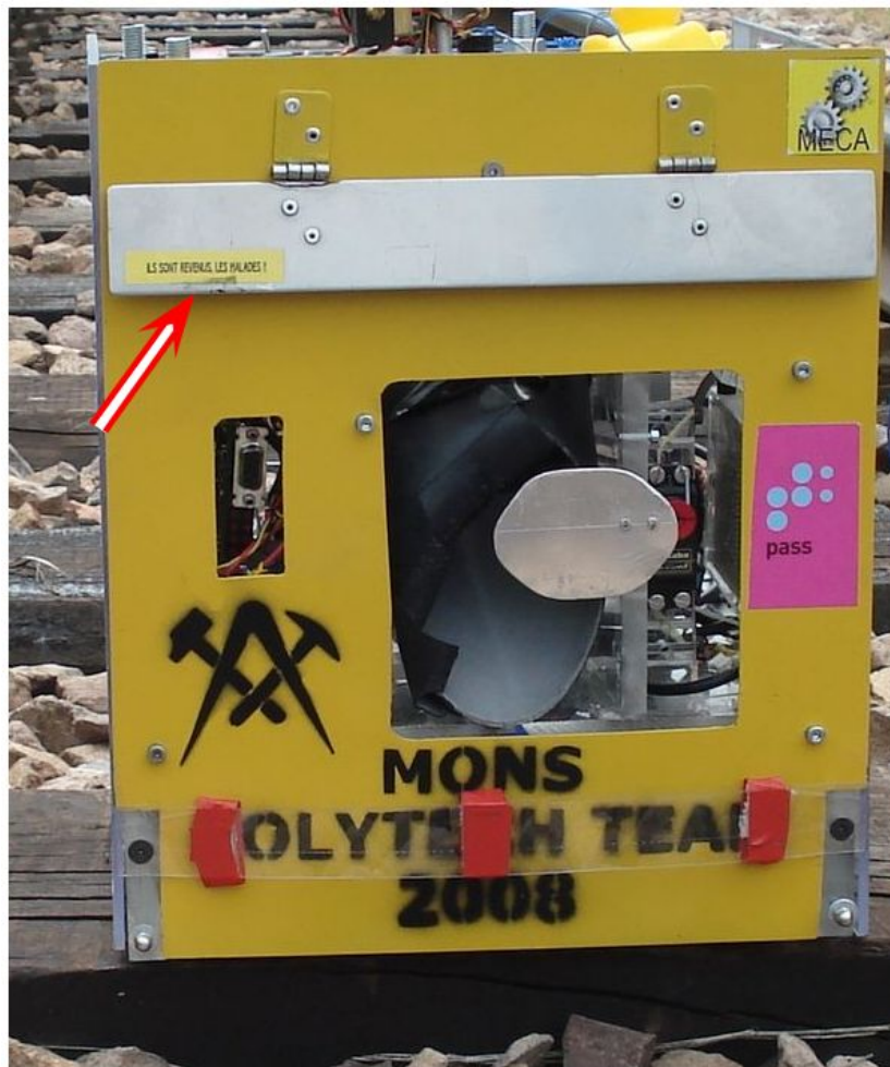
FIG. 14.10 – Bumper placé à l'avant du robot
