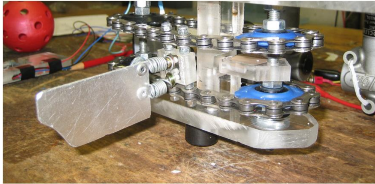
FIG. 6.6 – Système d'avalement à double chaîne
