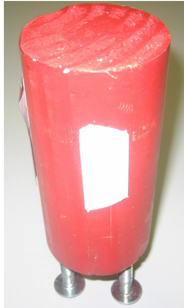
FIG. 12.2 – Balise laser recouverte de bande réfléchissante
