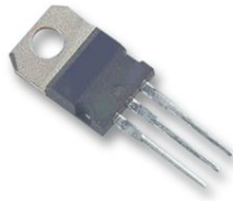
FIG. 14.7 – Régulateur de tension de type 7805
