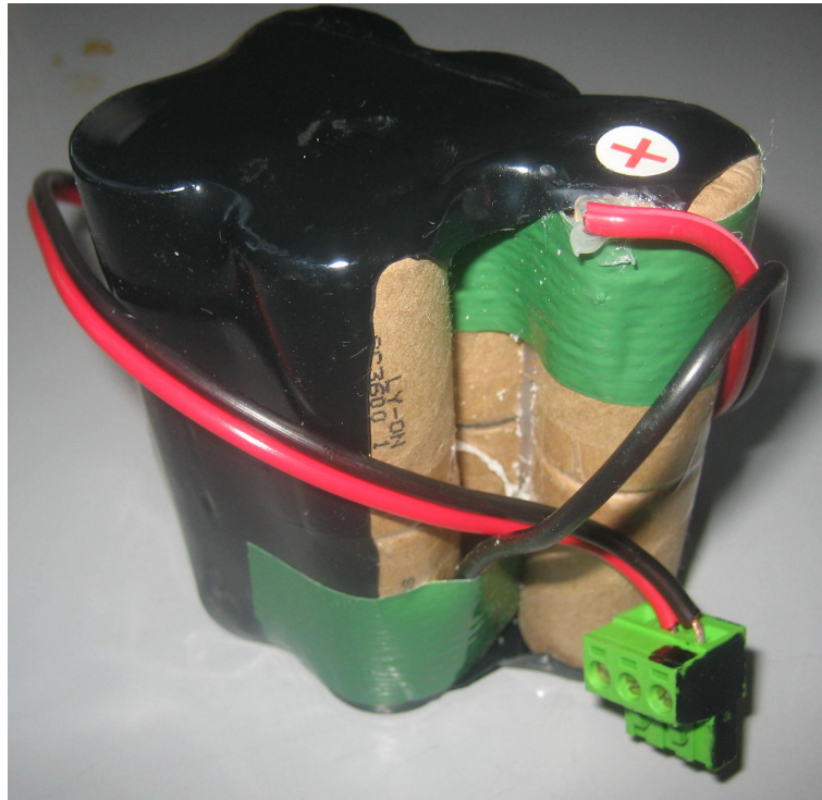
FIG. 13.1 – Batterie Ni-Cd 12 Volts
