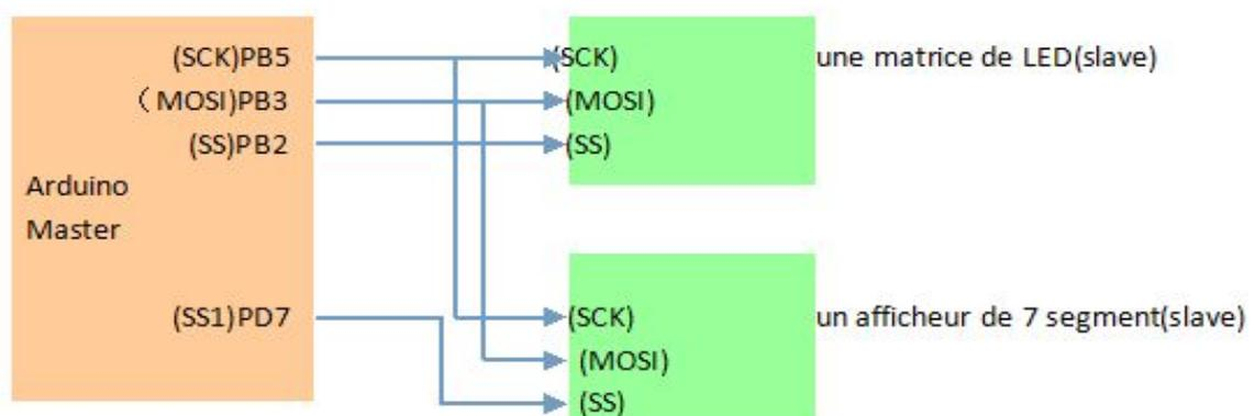
Pour utiliser le bus SPI, il faut utiliser les fonctions ci-dessous:
