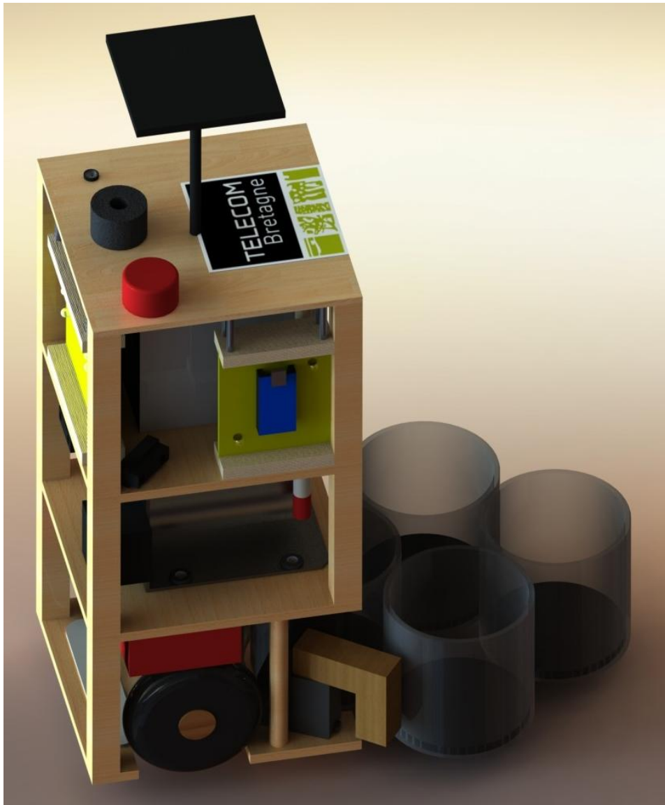
Figure 59 : Modélisation du robot complet, avec des verres dans son espace de stockage
