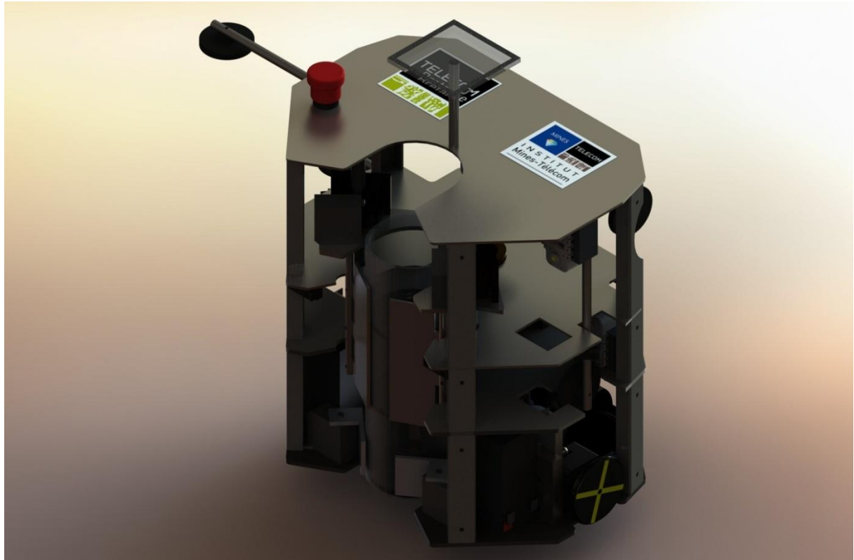
Figure 50 : Modélisation du robot principal, avec une pile de trois verres dans sa soute
