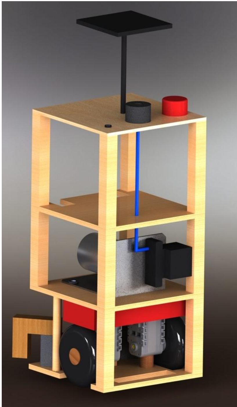
Figure 56 : Modélisation du système de pompe à vide, pour le gonflage du ballon
