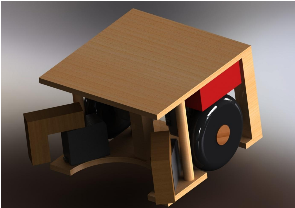
Figure 54 : Modélisation en trois dimensions de la base roulante de Krabi Junior
