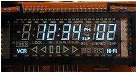
Ce type d'écran est composé d'une cathode chauffée (filaments), d'anodes (au phosphore) et de grilles, le tout scellé dans une enveloppe de verre où règne un vide poussé. La cathode est composée de fils de tungstène fins, entourée d'oxydes de métaux alcalino-terreux qui émettent des électrons lorsqu'ils sont chauffés par le passage d'un courant électrique. Ces électrons sont contrôlés et diffusés par les grilles faites de
