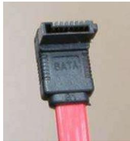
Le câble utilisé par le Serial ATA est plat (et rouge), est composé de sept fils et terminé par un connecteur de 8 mm.
