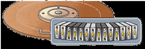
La technologie d'enregistrement perpendiculaire met en oeuvre des têtes TMR (tunneling magneto-resistive) utilisant un faisceau d'électrons, un média à 2 couches perpendiculaires et des technologies avancées de traitement du signal. Une couche de transport pour
