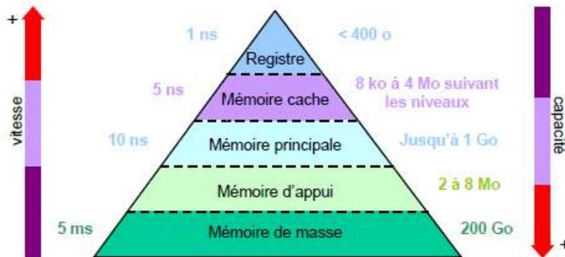
Outre la cache et la mémoire virtuelle, il existe plusieurs sortes de mémoires. La mémoire est un dispositif permettant de conserver des données tant qu'on en a besoin et de les restituer sur demande. Le plus petit élément de mémoire est le bit (élément binaire). L'unité de mémoire s'exprime en kilo-octets. Un octet est composé de huit bits (huit éléments binaires) et peut coder un caractère, un kilo-octet (ou ko) vaut
