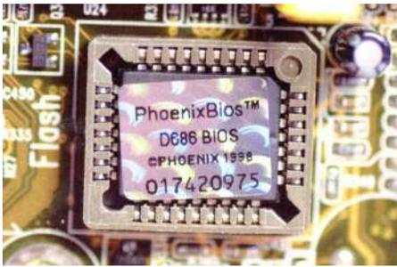
BIOS (Basic Input/Output System - Système de base d'entrée/sortie).
