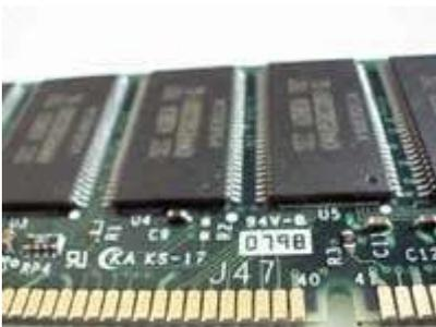
Les modules SDRAM (Dual Inline Memory Modules ou DIMM) sont équipés d'un connecteur à 168 broches et de deux encoches correspondant au connecteur sur la carte mère. Ces broches prennent en charge la connexion des données parallèle 64 bits avec le jeu de puces, l'alimentation et l'information complémentaire (vitesse d'horloge, latence, etc.) sur le module. Les encoches (détrompeurs) garantissent que le module ne puisse être enfilé que d'une seule manière et seulement dans le connecteur adéquat.
