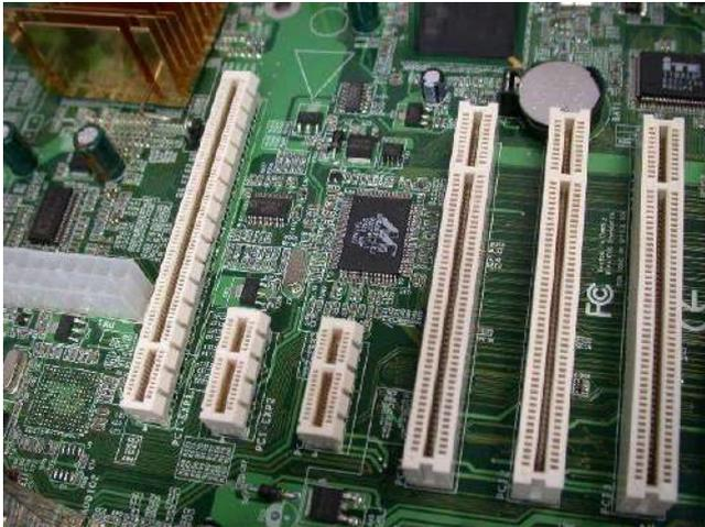
Le slot PCI Express 1x ressemble aux anciens connecteurs AMR ou CNR. Quant au slot PCI Express 16x, il est relativement long et ressemble à un connecteur PCI standard dont la forme aurait été inversée et est en fait constitué de 16 liens PCI Express 1x pour offrir une bande passante de 4 Go/s par sens.
