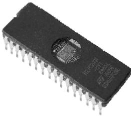
Bien que reprogrammable et non volatile, il est Impossible de sélectionner une seule cellule à effacer et il est impossible d'effacer la mémoire directement sur le pc (il faut placer le chips sur le programmeur d'EPROM où l'écriture est particulièrement lente).
