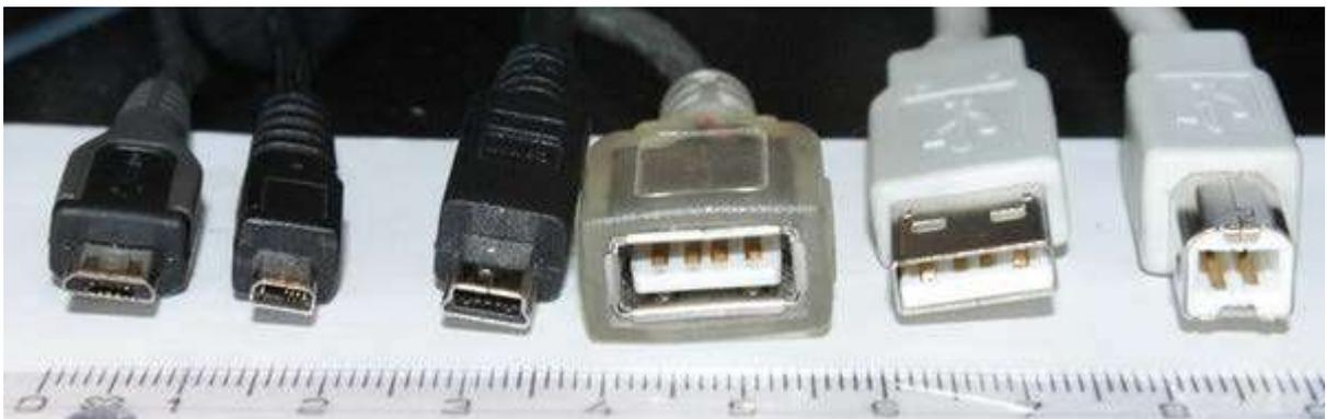
A droite en blanc, les connecteurs Type A et Type B, à gauche en premier le Micro Type-B et en troisième le Mini Type-B
