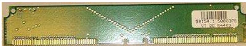
Dans le cas de mémoire Rambus, la notion de banque est abandonnée au profit du bus. Ce dernier ne doit en aucun cas être interrompu, il commence au contrôleur et se
