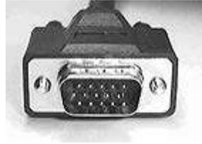
Ce connecteur est basé sur une interface analogique. Il a équipé la totalité des écrans CRT (à tube) ainsi que les écrans plats analogiques.
