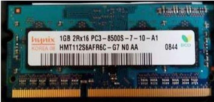
**1GB** : capacité de la RAM (de 128Mo jusqu'à 64 Go selon le type de la RAM DDR1, 2, 3 ou 4). **2RX16** : type de la RAM et distribution des chipsets en un seul ou deux rangs et sur une ou deux faces de la barette - le R signifie le nombre de banks de mémoire par module, (2R correspond à un module "dual rank"). **x16** indique la densité de chaque module. **8500S** donne la vitesse du module lui-même (la vitesse de
