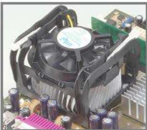
Le processeur doit toujours être parfaitement ventilé et refroidi. S'il surchauffe, il peut endommager la carte-mère ou s'arrêter de façon intermittente, provoquant un arrêt général du système. Dans le pire des cas, le processeur peut physiquement se fendre. Le
