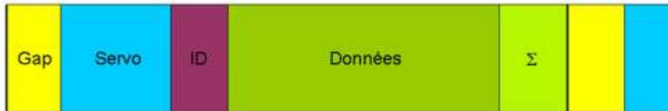
Format d'un secteur. Il ne contient pas seulement les données stockées, mais aussi un préambule permettant de synchroniser le système d'asservissement du disque, un entête avec l'identifiant du bloc et enfin une somme de contrôle ( $\Sigma$ ) permettant de détecter d'éventuelles erreurs.
