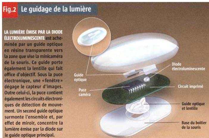
outre une bonne rapidité d'analyse des mouvements. La source lumineuse est une diode électroluminescente (rouge). Le faisceau de la diode est envoyé vers le bas par réflexion sur un pan oblique de cette pièce, laquelle comporte également une lentille moulée qui constitue l'objectif.
