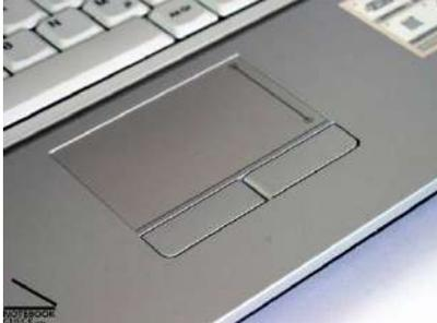
Un pavé tactile ou touchpad est un dispositif de pointage utilisé principalement sur les ordinateurs portables.
