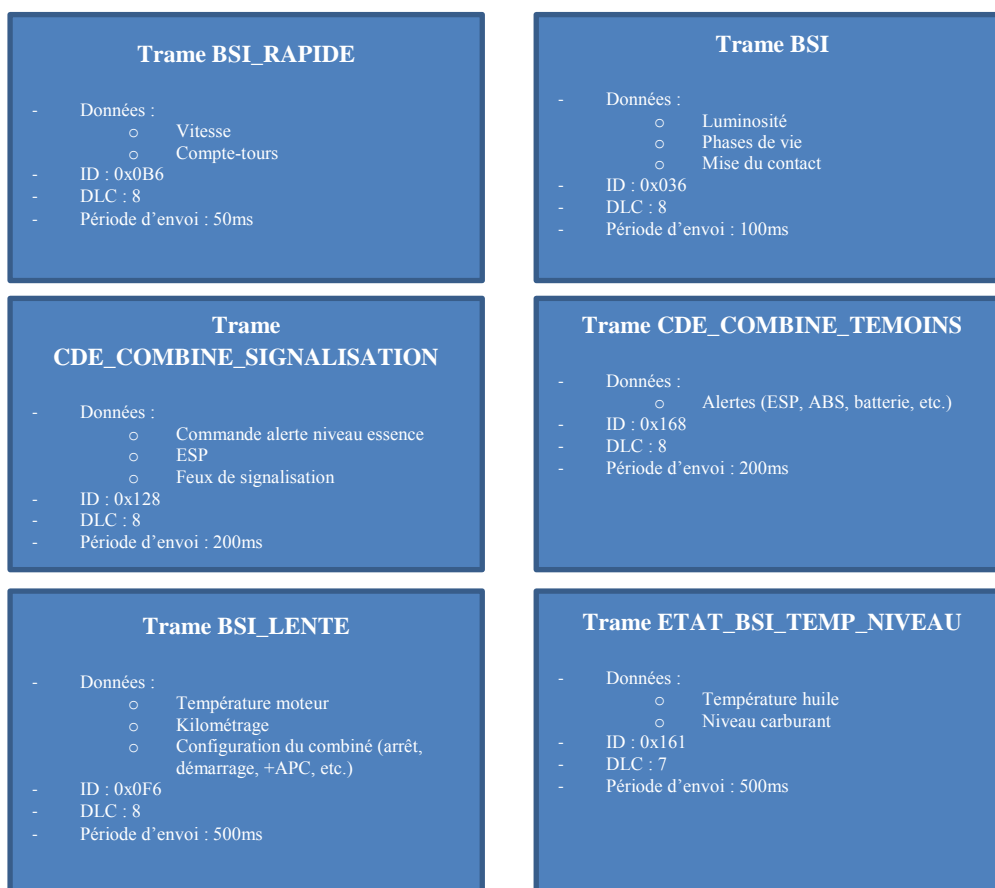
Figure 28 - Description des trames CAN de contrôle du tableau de bord
