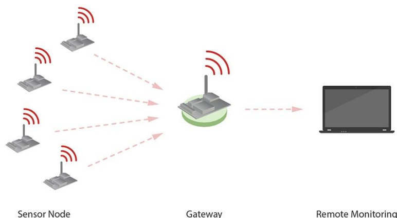
Figure 4 : Exemple de réseau en étoile
