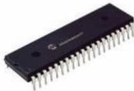
Figure 31: Le microcontrôleur Microchip PIC18F4580
