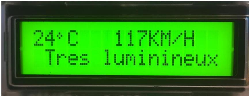
Figure 40: Afficheur LCD
