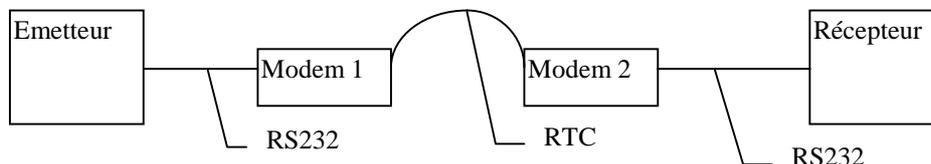
Sur TX/RX, circulent les données qui sont échangées entre l'émetteur et le récepteur.
