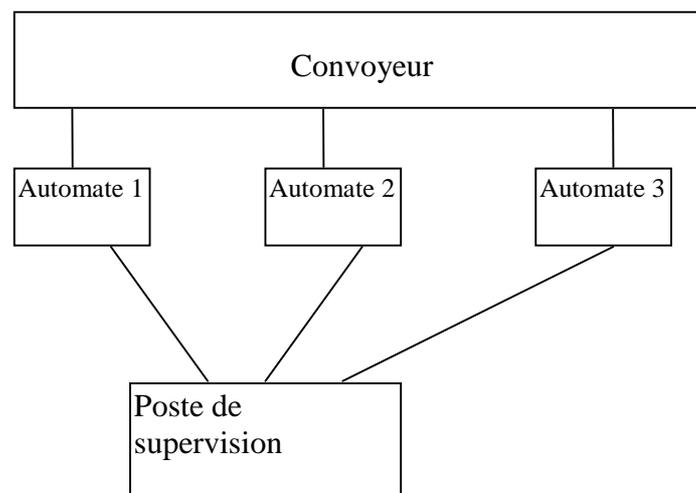
Sur le convoyeur vont circuler des pièces qui seront transformées par les différents automates.
