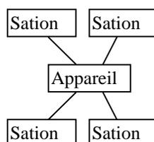
Ce câblage de type étoile respecte également le principe CSMA/CD d'Ethernet puisque l'appareil (passif) rémet l'informations vers toutes les stations.
