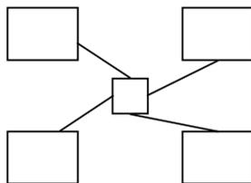
Chaque machine est reliée par un câble à un appareil *actif*. Ce type de câblage peut être utilisé dans une architecture réseau de type bus ( Ethernet XXX BT). L'élément actif recopie alors l'information sur chacun des câbles. Dans une architecture de type anneau l'appareil réemet les informations sur un seul câble à la fois.
