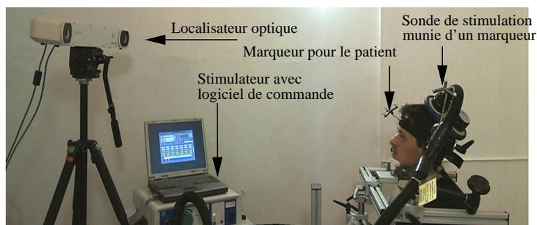
FIG. 2.2 – Dispositif de SMT avec outil de navigation.
