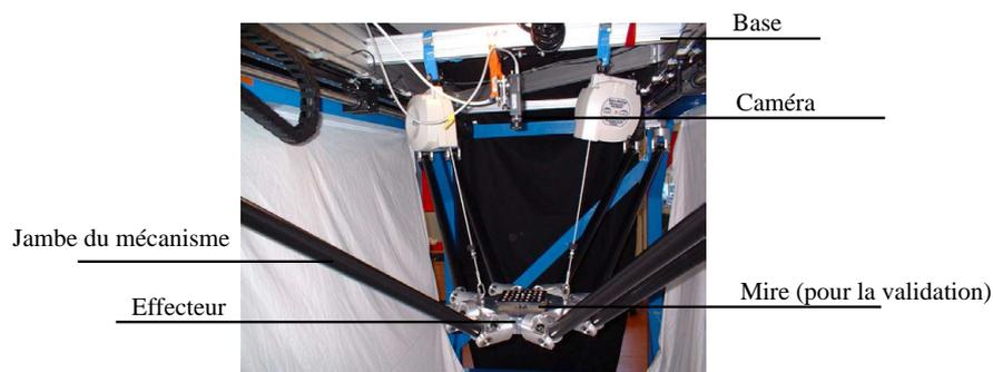
FIG. 1.3 – Exemple d'identification géométrique par observation des jambes : expérimentation sur le robot I4L.
