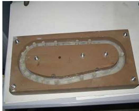
2 Réalisation du moule de la pièce en silicone
