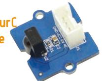
Ce module est utilisé pour recevoir les signaux infrarouges et également utilisé pour la réception de signaux de télécommande. Distance inférieure à 10 m.
