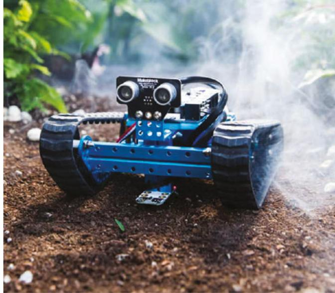
Le mBot Ranger est idéal pour appréhender l'enseignement des bases de la robotique ludique. Ce dernier est composé de pièces mécaniques en aluminium, de 2 moteurs à courant continu avec encodeur et d'une multitude de capteurs qui le rendent polyvalent et puissant.
