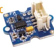
Ce module accéléromètre 3 axes Grove est basé sur le circuit ADXL345.
