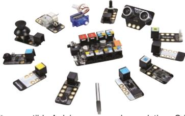
Le starter-kit compatible Arduino comprend une platine «Orion» associée à une multitude de modules d'extensions: capteur de température, capteur de lumière, télémètre à ultrasons, potentiomètre, joystick, moteur à courant continu, servomoteur, détecteur de présence, micro, module de communication Bluetooth™, détecteur infrarouge, etc...
