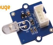
L'émetteur infrarouge est utilisé pour transmettre des signaux infrarouges à travers une LED infrarouge. Longueur d'onde centrée autour de 940 nm. Portée 10 m
