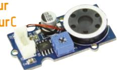
Ce module amplificateur permet de générer différents sons en fonction de la fréquence d'entrée. Volume ajustable via un potentiomètre.
