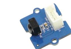
Ce module est utilisé pour recevoir les signaux infrarouges et également utilisé pour la réception de signaux de télécommande. Distance inférieure à 10 m.
