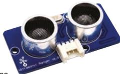
Ce module intègre un télémètre à ultrasons. Portée de détection: 3 cm à 4 m.
