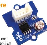
Le capteur de lumière détecte l'intensité lumineuse ambiante. La résistance décroît lorsque l'intensité lumineuse augmente.
