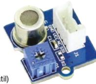
Détecte les gaz COV (composé organique volatil) comme le HCHO, le toluène, le benzène et l'alcool. La sensibilité est réglable. Plage de mesure : 1 à 50 ppm.
