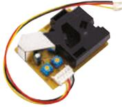
Ce module permet de mesurer la quantité de particules de plus de 1 µm présentes dans l'air. Applications : détecteur de fumée de cigarette.
