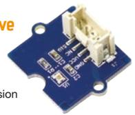
Ce module Grove converti l'intensité lumineuse en une tension linéaire (0-2,3V)
