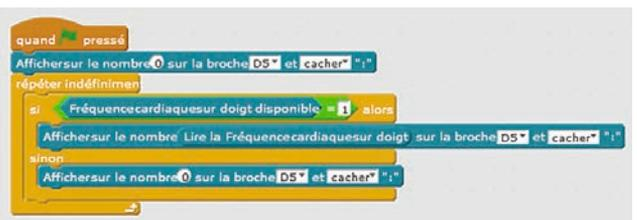
Exemple de codage pour mesurer et afficher la pulsation cardiaque. Autre exemple disponible. Calculer la fréquence cardiaque en mesurant le temps écoulé entre 2 pulsations cardiaques.
