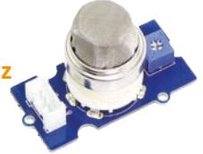
Ce capteur de gaz détecte les fuites d'hydrogène, de GPL, de méthane, de monoxyde de carbone, d'alcool, de fumée, de propane.
