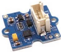
Cette boussole 3 axes Grove est basée sur le circuit HMC5883L de Honeywell.
