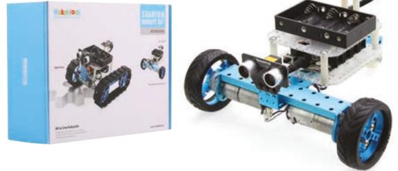
Plus puissant et plus imposant que son petit frère mBot, le Starter Robot Kit offre une base idéale pour les défis les plus exigeants. Il est composé de diverses structures mécaniques en aluminium anodisé (poulies, profilés, équerres...), de 2 puissants moteurs à courant continu, des roues, une roue folle, des chenilles en caoutchouc, un capteur à ultrason, une télécommande infrarouge, un récepteur IR et une carte programmable compatible Arduino™.
