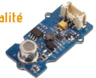
Ce module est conçu pour tester la qualité de l'air dans des pièces fermées. Détecte le CO, l'alcool, l'acétone, le formaldéhyde et d'autres gaz.
