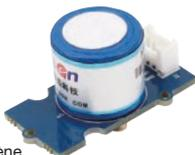
Ce module Grove permet la mesure de la concentration d'oxygène dans l'air avec une bonne précision. Plage de mesure : 0-25%. Durée de vie 2 ans.
