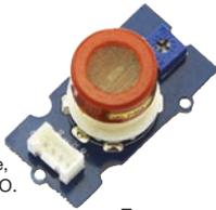
Module Grove basé sur le capteur de gaz MQ3 permettant de détecter l'alcool, l'essence, le méthane, le GPL et le CO.
