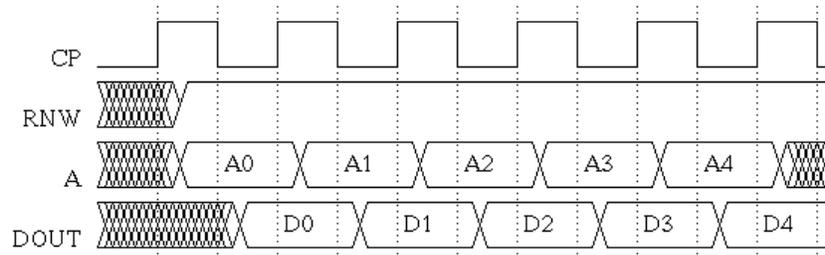
Le tableau suivant montre l'horloge (« CP »), le « Read/Write » (« RNW »), l'adresse (« A ») et les données (« DIN ») d'un cycle d'écriture de la RAM.
