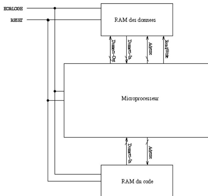
Toutes les entrées ou fils se composent de 16 canaux, sauf le « Read/Write », l'« Horloge » et le « RESET ». Ils n'ont qu'un canal.
