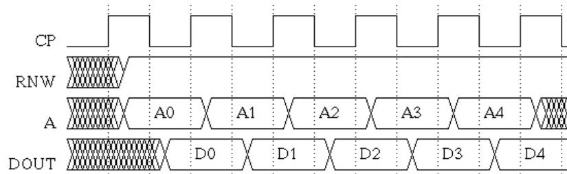
Le tableau suivant montre l'horloge (« CP »), le « Read/Write » (« RNW »), l'adresse (« A ») et les données (« DIN ») d'un cycle d'écriture.
