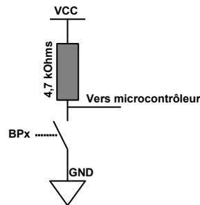
Lorsque le bouton n'est pas enfoncé, il se comporte comme un interrupteur ouvert. Grâce à la résistance de pull-up, le signal reçu par le micro-contrôleur sera VCC, ici 5V. Les entrées du micro-contrôleur n'absorbant pas de courant, la résistance n'est parcourue par aucun courant.
