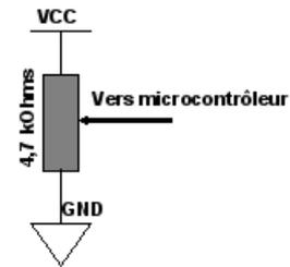
L'entrée du micro-contrôleur n'absorbant pas de courant, le montage est un simple diviseur de tension. Pour une position *pos* du curseur du potentiomètre, l'entrée analogique du micro-contrôleur reçoit donc la tension suivante :
