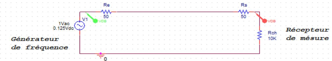
Figure IV. 36 : circuit sans filtre
