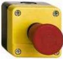
De type normalement fermé, cet interrupteur sera traité au niveau du microcontrôleur de la même manière qu'un fin de course, de plus il agira aussi directement sur l'inhibition des couples moteurs afin d'assurer une sécurité maximale.
