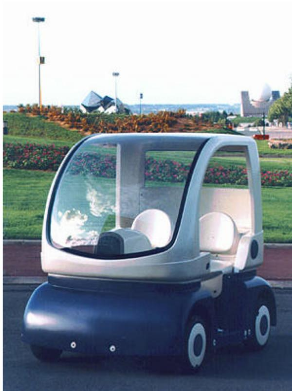
Un poste central de contrôle se charge de localiser et de commander le déplacement des "CyCab" vides de manière automatique afin de répondre rapidement aux fluctuations de la demande. Par exemple, le ramassage et la redistribution des véhicules vides vers les stations déficitaires peuvent se faire par téléopération ou sous la forme de trains de véhicules à accrochage immatériel.
