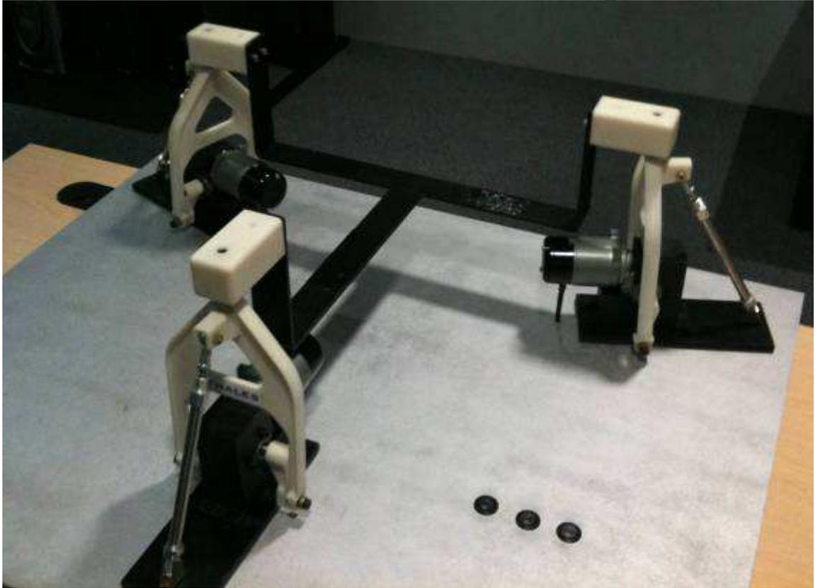
Figure 36 : La maquette du MEMS3X assemblée
