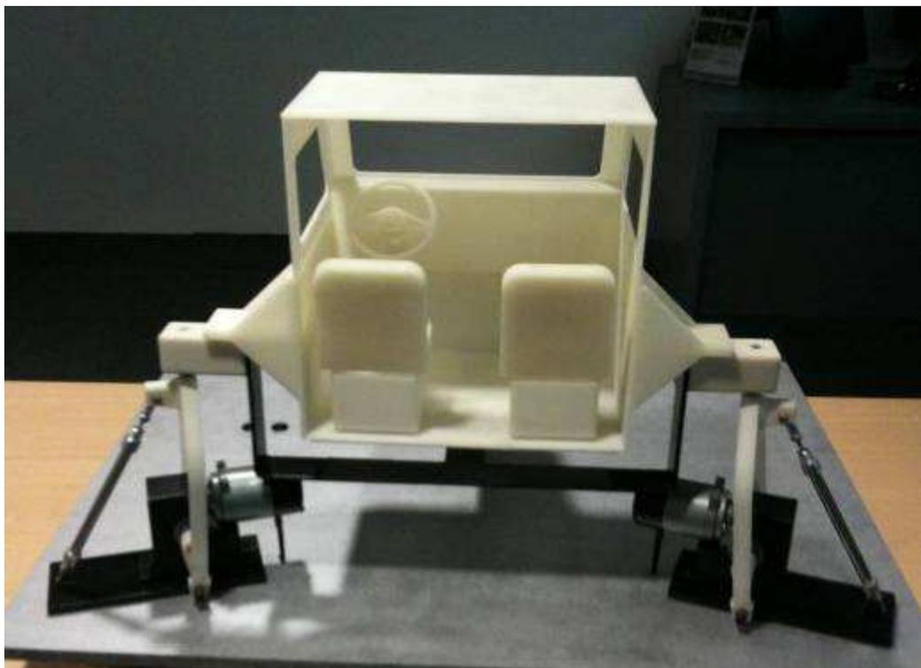
*Figure 43 : Ensemble maquette & cabine- vue arrière*
