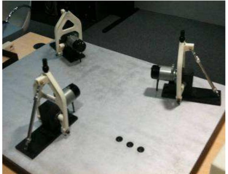
Figure 34 : Dispositions des trois actionneurs sur leur socle
