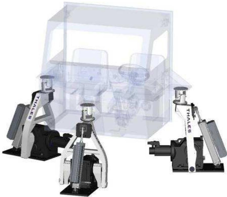
*Figure 25 : Schéma du MEMS3X avec cabine en transparence*
