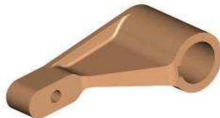
Figure 27 : Modèle CAO de la manivelle
