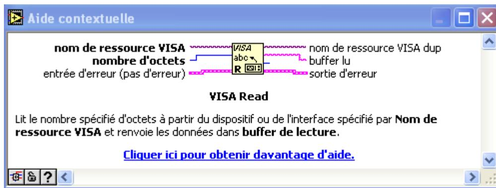
*Figure IV.16 : Exemple de fenêtre d'aide offrant la description d'une fonction fournie dans la bibliothèque de LabVIEW*
