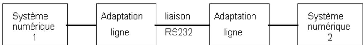
**Figure III.11 schéma fonctionnel d'une liaison série asynchrone de la norme RS232**
