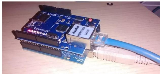
**Figure 47: L'Arduino UNO avec le Shield Ethernet**
