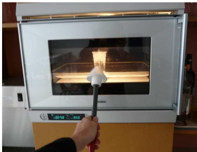
Figure 31: Mesure des fuites électromagnétiques sur la grille d'un four micro-ondes
