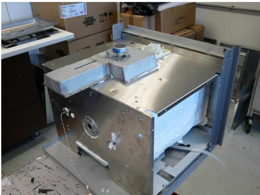
Figure 34: Prototype équipé du diffuseur et du guide d'ondes
