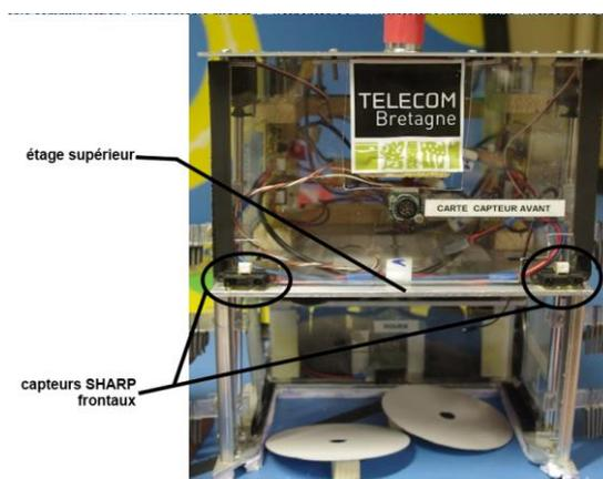
**Figure 13:** Vue sur l'étage supérieur du robot avec les capteurs SHARP frontaux visibles
