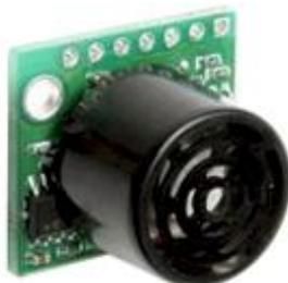
**Figure 58:** capteur ultrason
