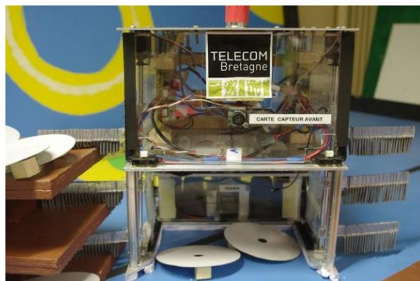
**Figure 15:** Les balais latéraux déployés sur le robot longeant un des totems
