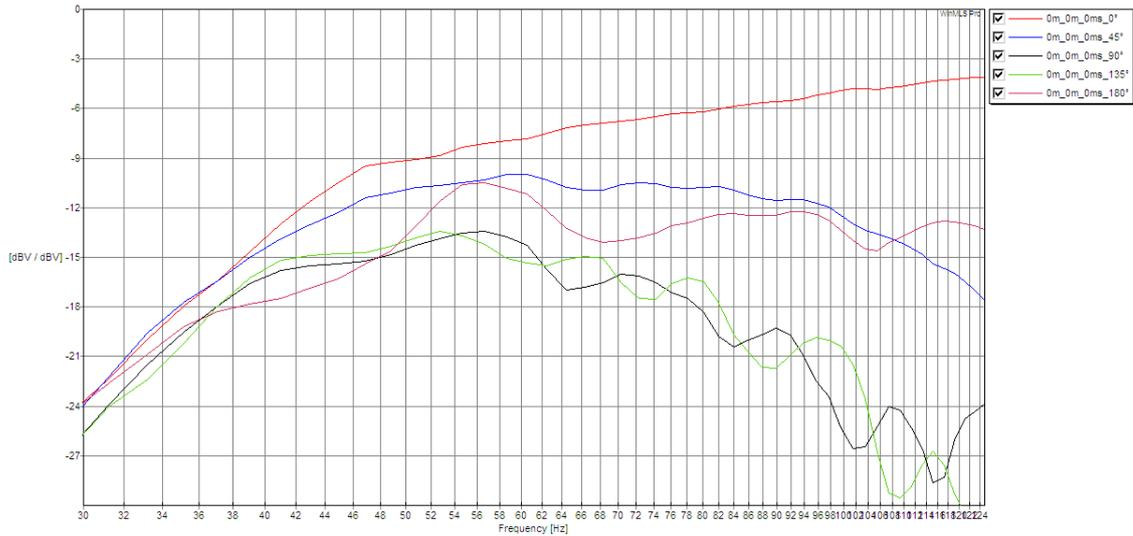
FIGURE 5.4 – Réponse en fréquence de quatre enceintes SPEKTRIX SUB alignées en fonction de l'angle
