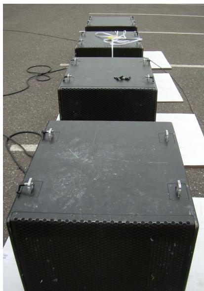
FIGURE 7.2 – Placement pour la mesure du end fire.
