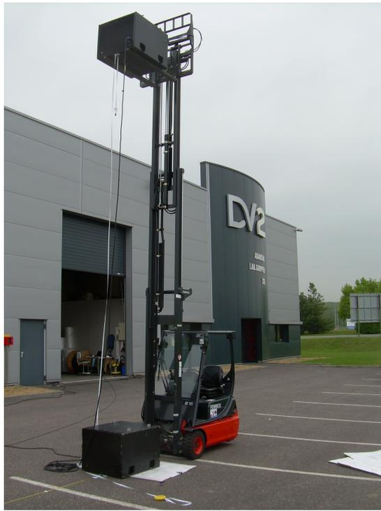
FIGURE 10.1 – Implantation de la mesure d'un système au sol couplé avec un système en hauteur
