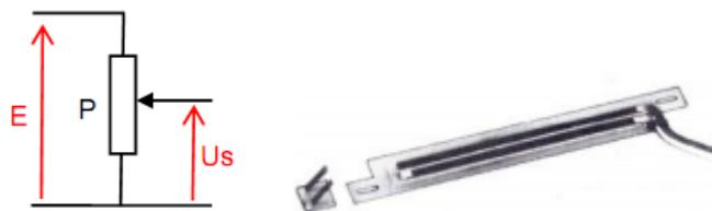
Figure 24 : Capteur résistif rectiligne
