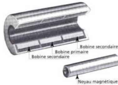
Figure 25 : Principe de capteur inductif
