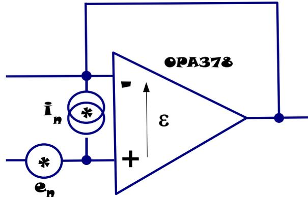
FIGURE 14.52 – Amplificateur OPA378 bruité en montage suiveur
