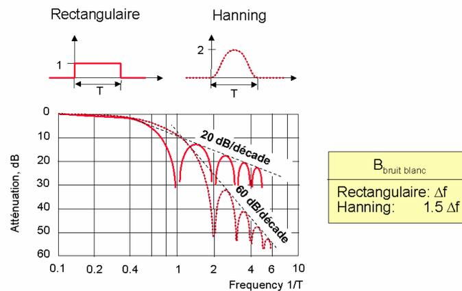
FIGURE 6.8 – Le spectre FFT est convolué au spectre de la fenêtre de pondération
