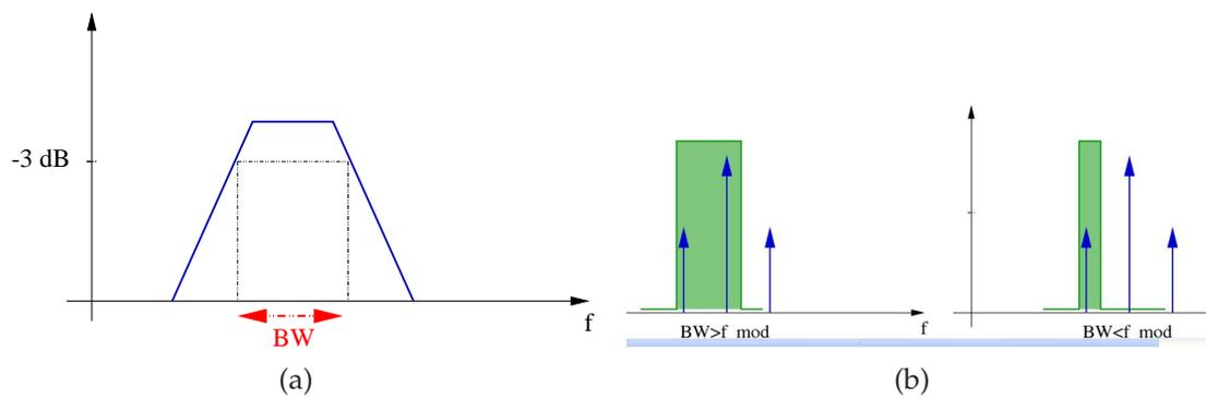
FIGURE 14.46 – Réponse fréquentielle du filtre analogique définissant le paramètre  $BW$  de l'analyseur de spectre HP8590. Dans les analyseurs de spectre analogiques, la bande spectrale d'analyse  $BW$  correspond à la largeur du filtre passe bande sélectif centré autour de la fréquence d'analyse  $f_0$  et permet la mesure de la puissance spectrale du signal
