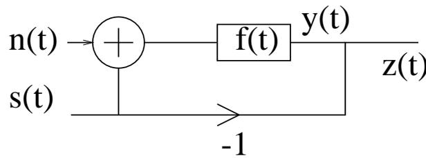
FIGURE 14.21 – Principe schématique du filtrage du signal  $s(t)$
