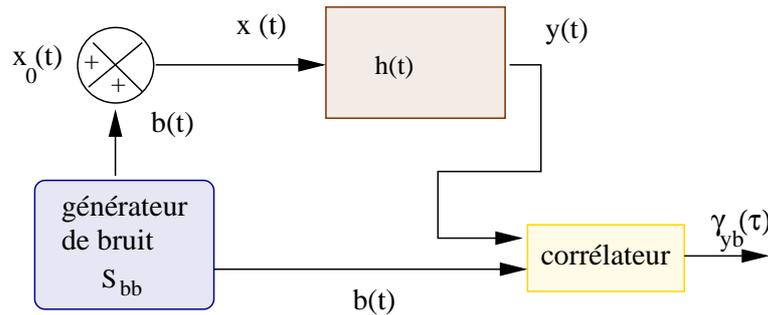
FIGURE 13.7 – Identification d'un système linéaire en fonctionnement
