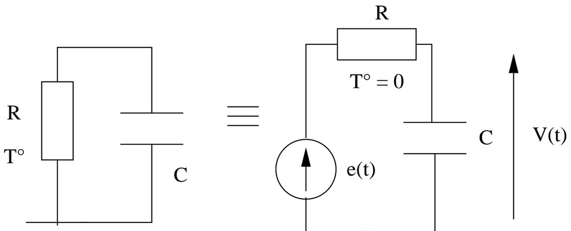
FIGURE 12.2 – Etude expérimentale du bruit thermique
