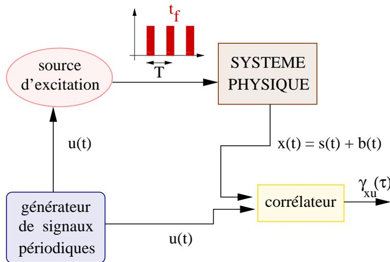
FIGURE 13.5 – Caractérisation d'un système physique par intercorrélation synchrone
