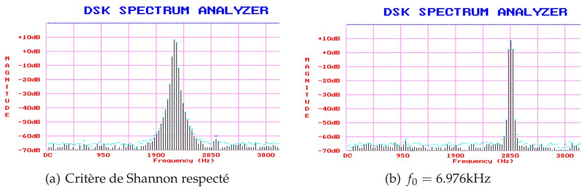
FIGURE 14.26 – Spectre FFT (dans un span partiel de 3800 kHz) délivré par le TMS320C50
