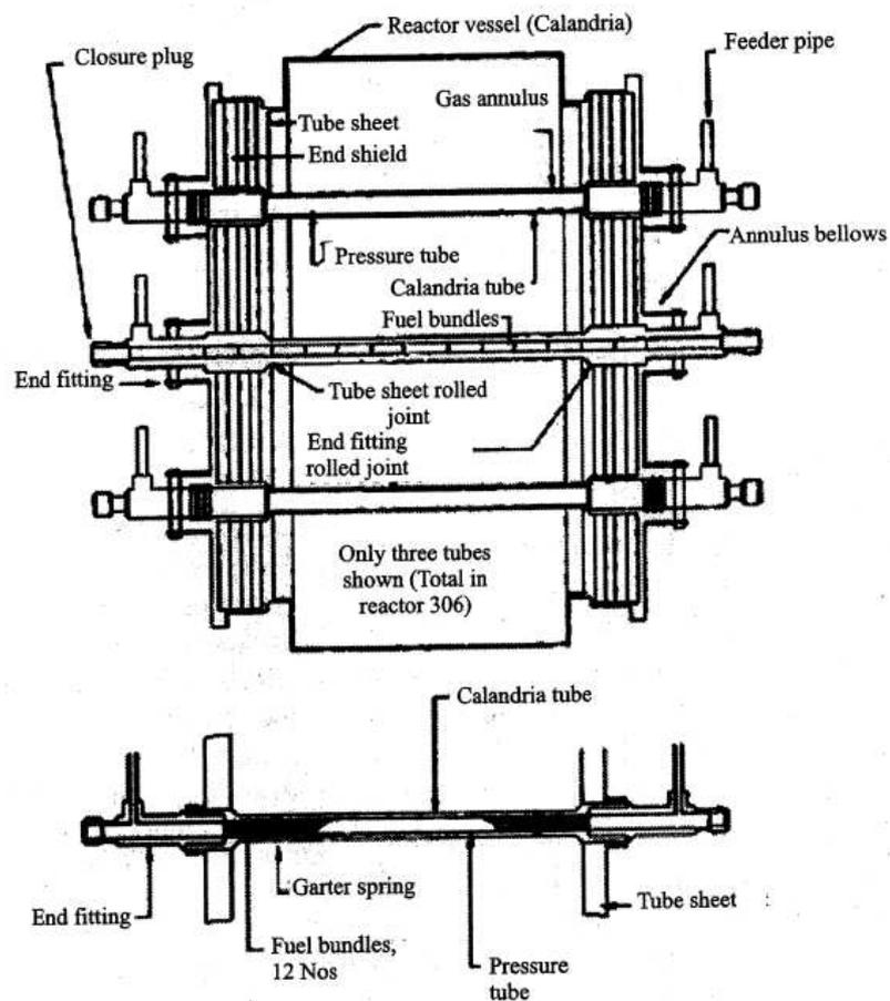
FIGURE 14.76 – Descriptif de l’assemblage des circuits de refroidissement dans l’échangeur thermique d’un réacteur nucléaire à eau pressurisé (PHWR). Les fissures sont détectées et localisées au niveau des CSTS, Calandria Side Tube Sheet (Baldev Raj *et al.*, "Practical Digital Signal Processing", ISBN 978-1-84265-681-5, Alpha Science International, 2011)
