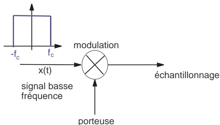
FIGURE 14.12 – Transmission de signal basse fréquence
