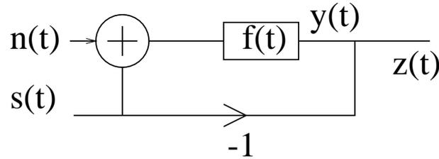
FIGURE 14.47 – Principe schématique du filtrage du signal  $s(t)$
