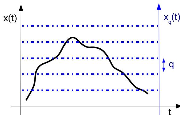
FIGURE 14.69 – Principe de quantification du signal  $x(t)$ . La plage de variation du signal est découpée en  $N$  intervalles de largeur  $q$  afin de générer un signal numérique  $x_q(t)$  (non indiqué ici) qui dépend du mode de conversion
