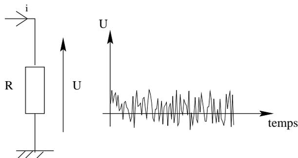
FIGURE 9.1 – Bruit thermique dans une résistance
