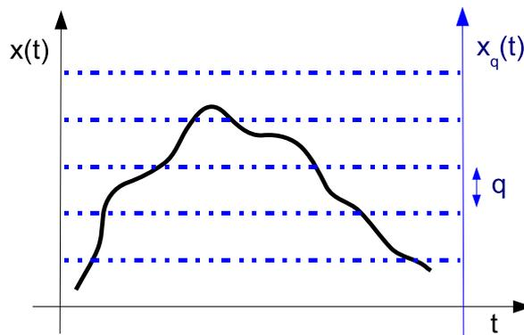
FIGURE 14.32 – Principe de quantification du signal  $x(t)$ . La plage de variation du signal est découpée en  $N$  intervalles de largeur  $q$  afin de générer un signal numérique  $x_q(t)$  (non indiqué ici) qui dépend du mode de conversion
