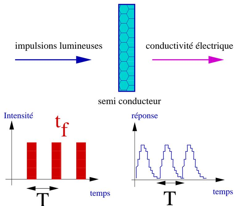
FIGURE 13.6 – Estimation d'un signal par intercorrélation synchrone
