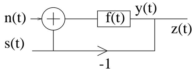
FIGURE 14.60 – Principe schématique du filtrage du signal  $s(t)$
