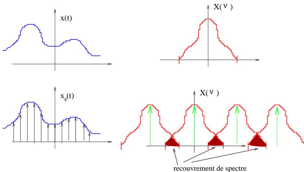
FIGURE 5.3 – Reconstitution de spectre avec recouvrement
