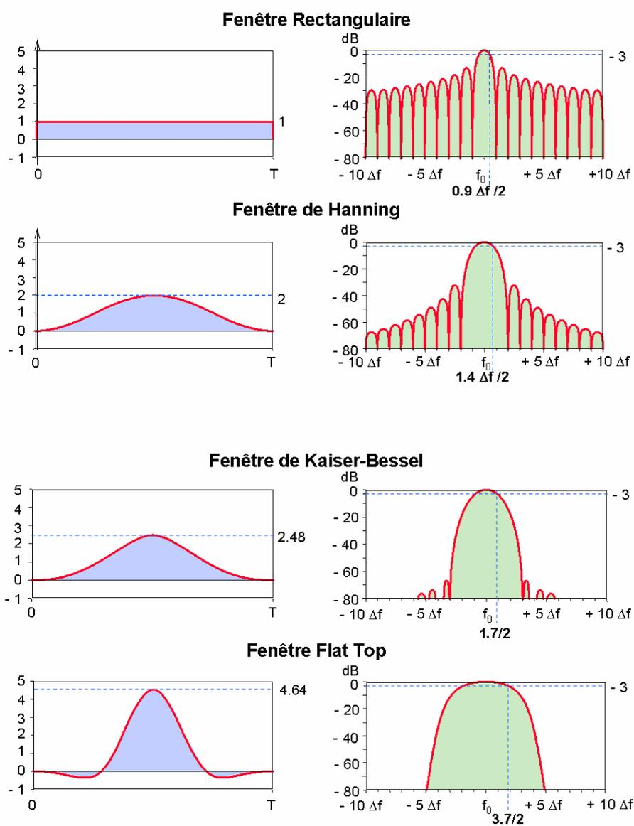
FIGURE 6.10 – Propriétés des différentes fenêtres de pondération utilisées pour la FFT
