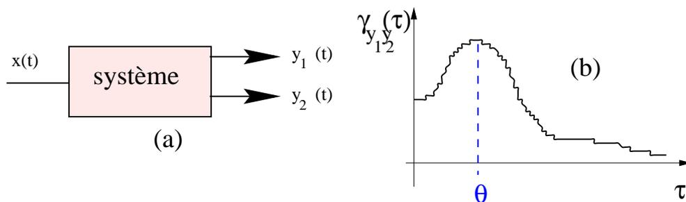
FIGURE 13.1 – Mesure de décalage temporel de 2 signaux
