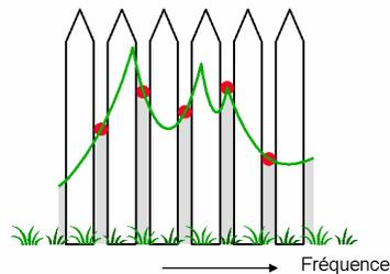
FIGURE 6.6 – Effet palissade dans le spectre FFT du à la fréquence d'échantillonnage du signal temporel
