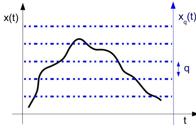
FIGURE 14.108 – Principe de quantification du signal  $x(t)$ . La plage de variation du signal est découpée en  $N$  intervalles de largeur  $q$  afin de générer un signal numérique  $x_q(t)$  (non indiqué ici) qui dépend du mode de conversion
