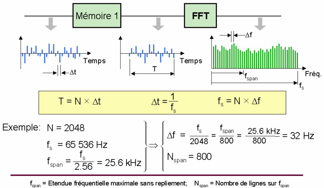
FIGURE 6.4 – Paramètres temporels et fréquentiel de l’analyseur FFT
