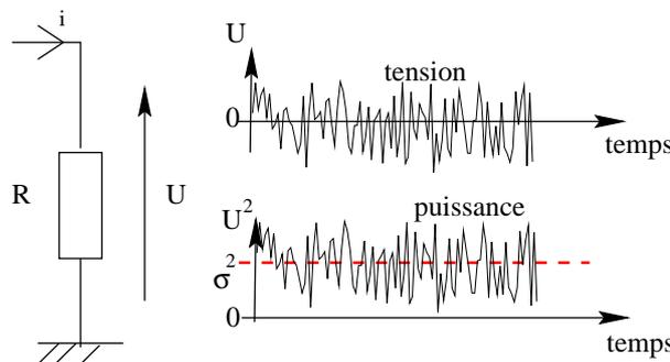
FIGURE 10.1 – Puissance de bruit thermique dans une résistance
