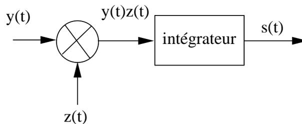
FIGURE 13.3 – Mesure de temps de propagation par intercorrélation
