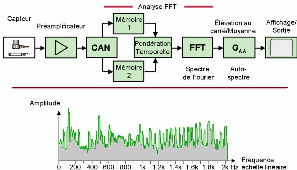
FIGURE 6.3 – Diagramme Bloc de l'analyseur FFT
