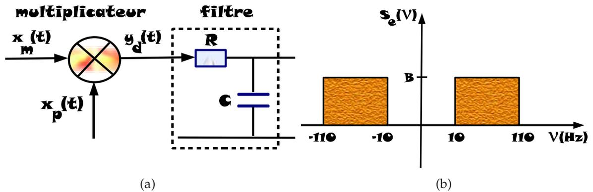
FIGURE 14.53 – (a) Système étudié. (b) Spectre du bruit  $e(t)$  supposé blanc dans la bande  $[10-110]$ Hz
