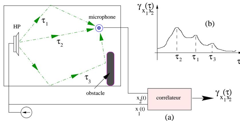
FIGURE 13.2 – Mesure de temps de propagation par intercorrélation
