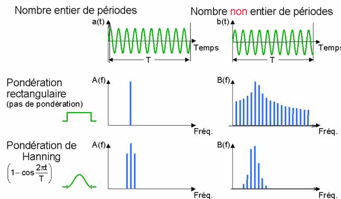
FIGURE 6.5 – Effet de fuite dans le spectre FFT du à la troncature du signal temporel
