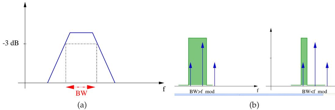
FIGURE 14.37 – Réponse fréquentielle du filtre analogique définissant le paramètre  $BW$  de l'analyseur de spectre HP8590. Dans les analyseurs de spectre analogiques, la bande spectrale d'analyse  $BW$  correspond à la largeur du filtre passe bande sélectif centré autour de la fréquence d'analyse  $f_0$  et permet la mesure de la puissance spectrale du signal
