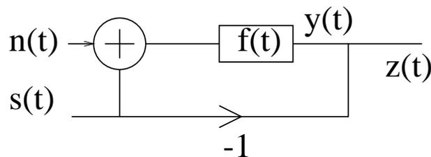
FIGURE 14.5 – Principe schématique du filtrage du signal  $s(t)$
