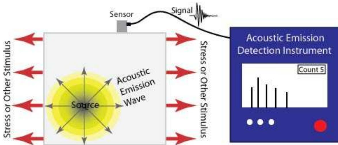
FIGURE 14.70 – Principe de base de l'Émission Acoustique (<http://www.ndt-ed.org/>)
