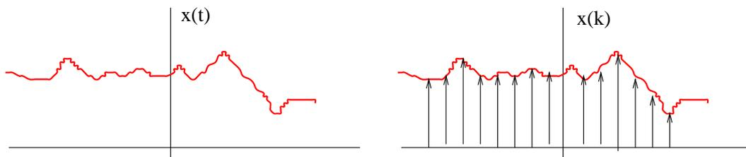
FIGURE 5.2 – Signal réel et signal échantillonné
