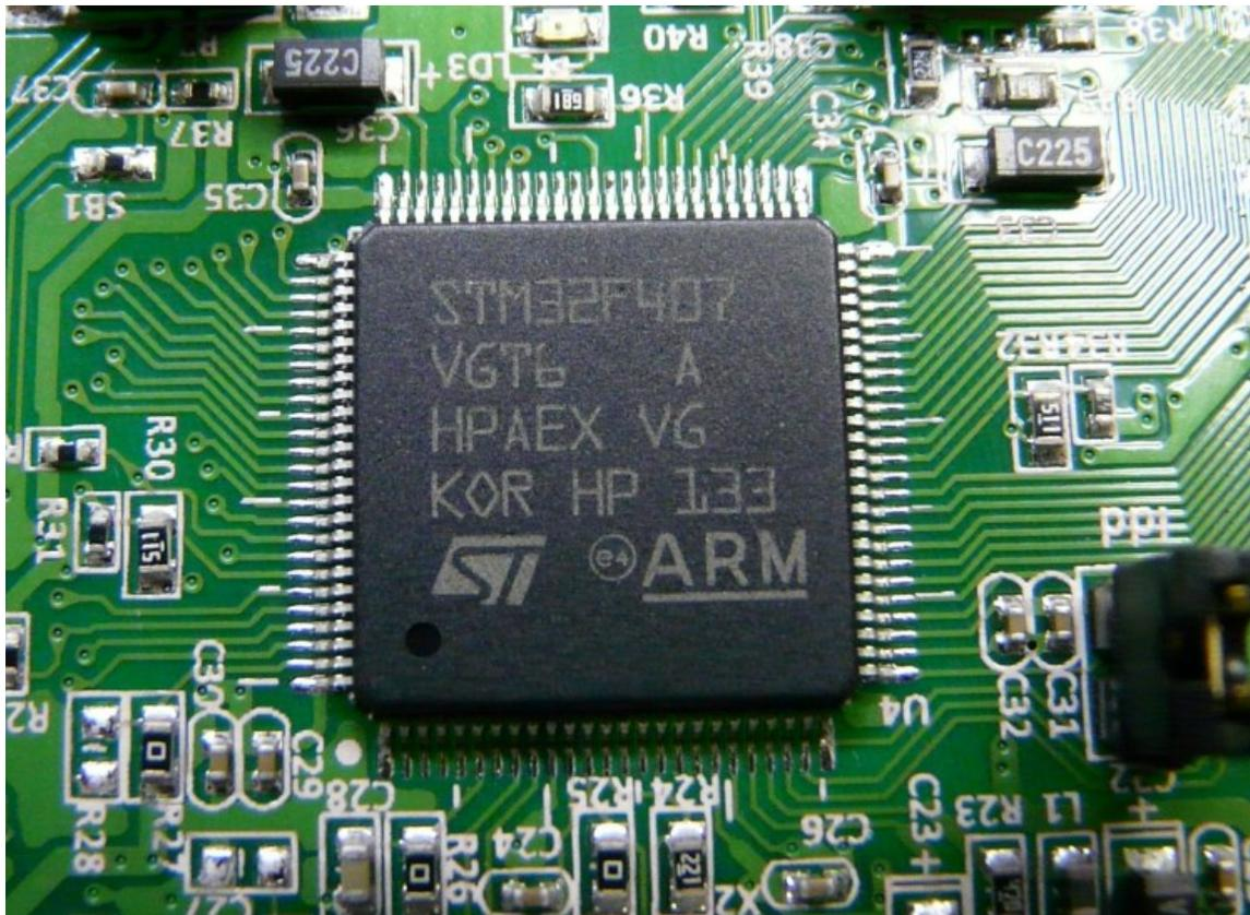
Figure 3 : Photo du microcontrôleur sur la carte de développement STM32F4DISCOVERY
