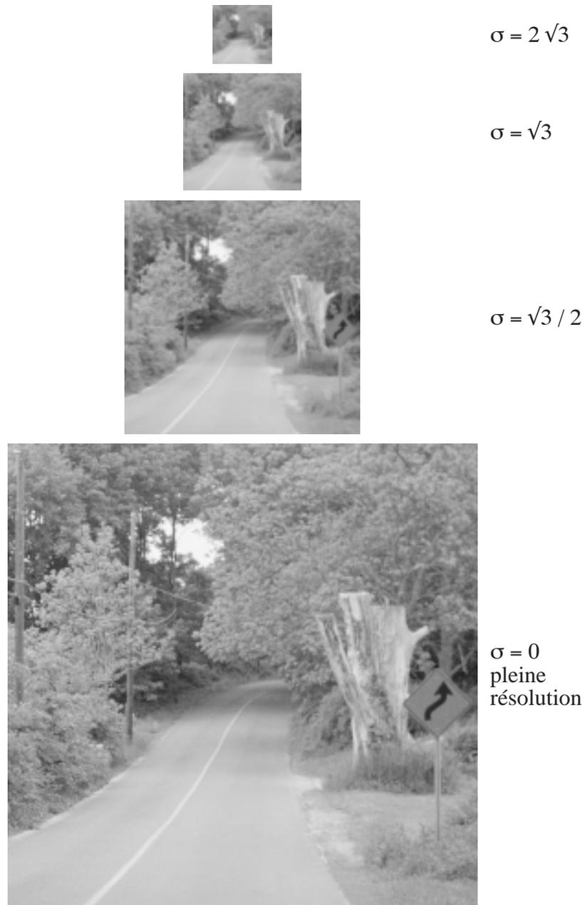
*Figure 3.6 Représentation pyramidale de la scène de route. Les représentations aux différentes résolutions sont obtenues en appliquant le même filtre passe-bas gaussien de largeur de bande  $\sigma = \sqrt{3}/2$  entre chaque niveau consécutif de la pyramide. La valeur de  $\sigma$  indiquée à chaque niveau de la pyramide est la fréquence de coupure effective.*
