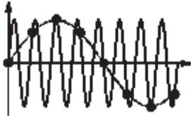
(b) Le signal échantillonné semble d'une fréquence plus faible que le signal original.
