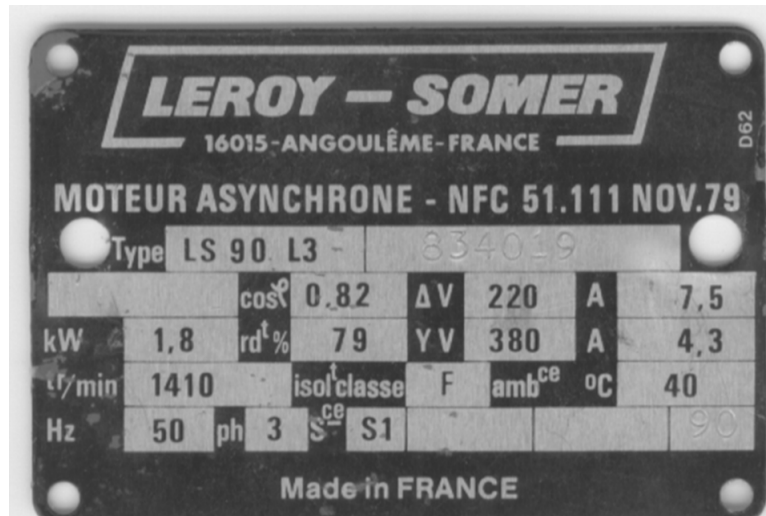
FIGURE 1.2 – Plaque signalétique d'une machine asynchrone.
