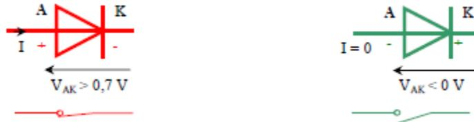
Figure 2. Sens direct la diode est passante Sens inverse : la diode est bloquée
