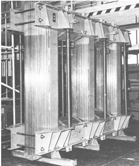
FIGURE 1.34 – Circuit magnétique à 3 colonnes, transformateur triphasé à flux liés.
