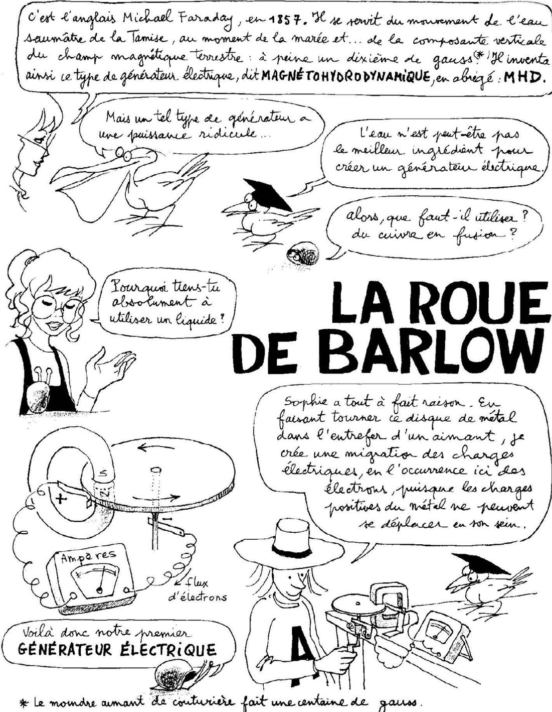
FIGURE 2.18 – Explication microscopique du fonctionnement d'une machine électrique.
