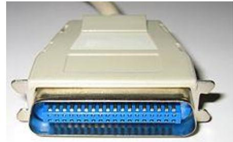
La transmission simultanée des 8 bits de données provoque des interférences entre les signaux lorsque la distance de transmission est longue et que la fréquence de transmission est importante.
