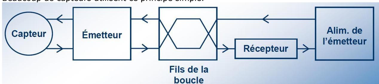
Une alimentation fournit l'énergie électrique et l'émetteur fait varier le courant de 4mA à 20mA. Lorsque le courant vaut 0mA le récepteur est informé d'un dysfonctionnement (boucle interrompue).
