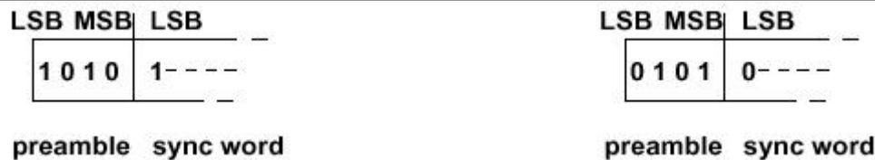
Figure 2-1 Format des fanions d'en-tête selon que le LSB du *Sync Word* est à 1 (fig de gauche) ou à 0 (fig de droite).
