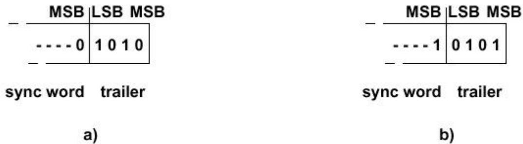
Figure 2-1 Fanion de queue lorsque le MSB du mot de sync est à 0 (a) ou lorsqu'il est 1 (b).
