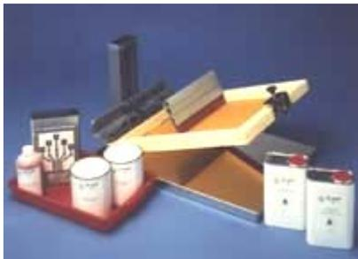
Il est possible aussi de réaliser un marquage de sérigraphie pour indiquer la position des composants à implanter. Ce procédé sérigraphique est le même que celui utilisé pour la reproduction d'œuvres d'art. Un cadre toile recouvert de cire photosensible est insolé avec un typon contenant le marquage selon le même procédé que la plaque de CI
