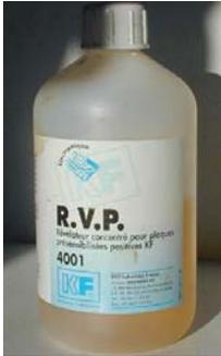
Il s'agit d'éliminer la résine photosensible dégradée par les UV au moyen d'une solution de révélateur chimique (lessive de soude). Une fois la résine dégradée éliminée, seule la résine épargnée des UV subsiste et protège encore le cuivre contre une attaque chimique.
