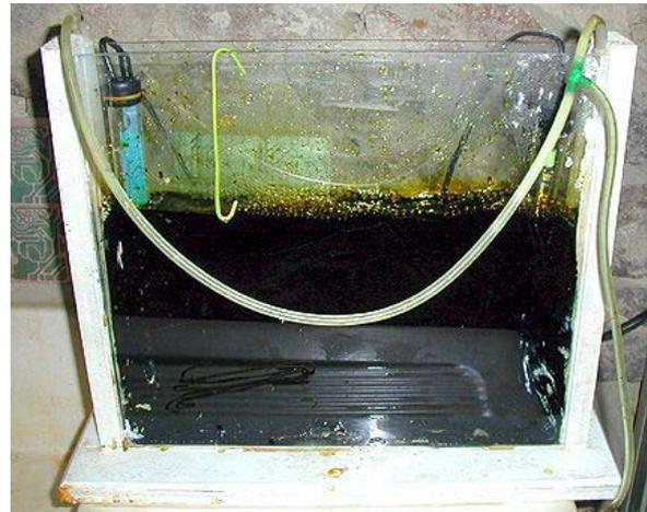
figure 18 : graveuse artisanale... avec chauffage et mousser
