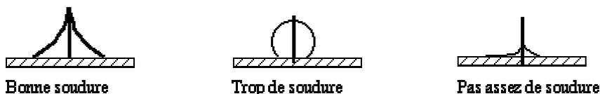
figure 22: vue en coupe de la soudure d'un composant traversant.
