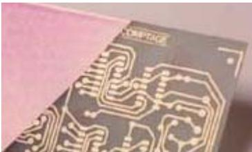
Il s'agit cette fois de faire agir un acide corrosif (perchlorure de fer) sur les parties de cuivre qui ne sont plus à l'abri de la résine photosensible. Le cuivre non protégé sera alors détruit sous l'effet de l'acide et laissera apparaître le support isolant du circuit imprimé. Cette opération se fait dans un bain d'acide chauffé à 50° et oxygéné par un mousser pour activer la réaction chimique avec le cuivre de la plaque.
