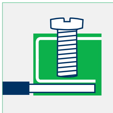
Système de connexion à languette déformable -principe du fil protégé-
