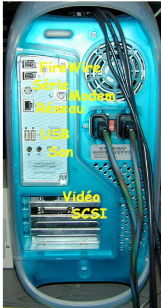
**Figure 13 : Face arrière d'un Macintosh G3 blanc bleu**
