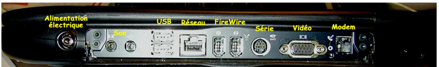
**Figure 14 : Face arrière d'un Power Macintosh Wall street (portable)**
