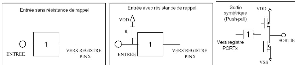
La mise en œuvre des ports parallèles nécessite en premier **la programmation du registre DDRx** pour définir si les broches du circuit sont en entrée ou en sortie.
