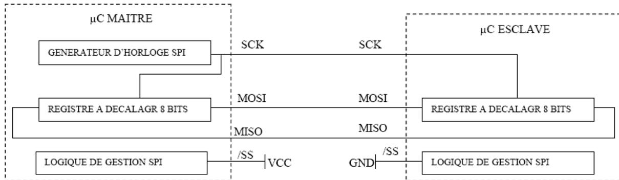
On constate que l'ensemble des 2 registres à décalage 8 bits forment un registre à décalage 16 bits unique partagé entre les 2 µC. L'émission d'un octet vers l'esclave par le maître provoque, la réception par le maître de la donnée contenue dans le registre de l'esclave.
