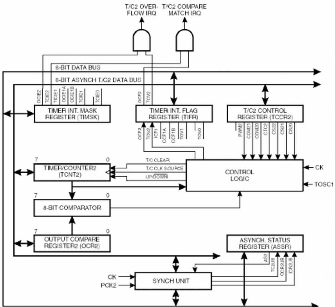
Le Timer 2 comporte un compteur 8 bits et un registre de comparaison qui peut agir sur la sortie OC2.
