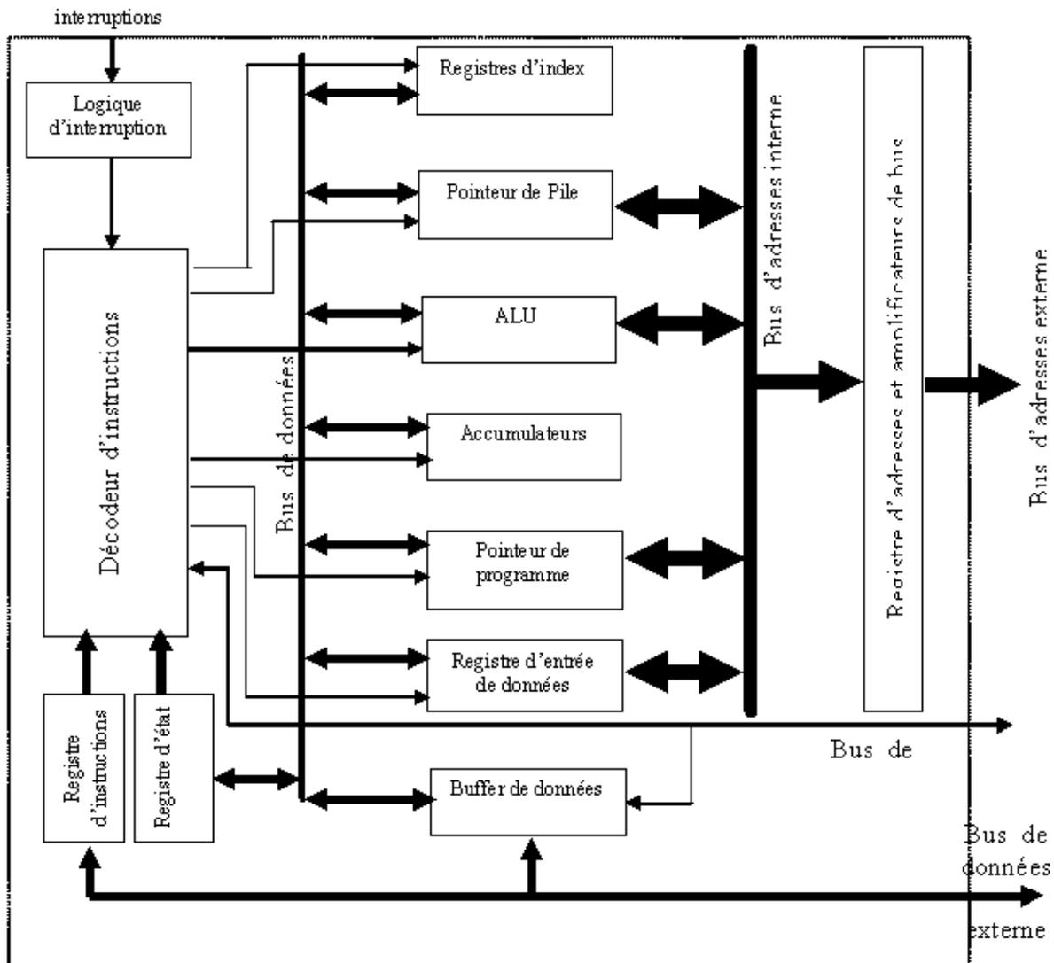
L'architecture interne du microprocesseur ci-dessus est une architecture de type « Von Neuman <sup>(1)</sup> » (**un seul bus de données**). Elle se compose essentiellement :
