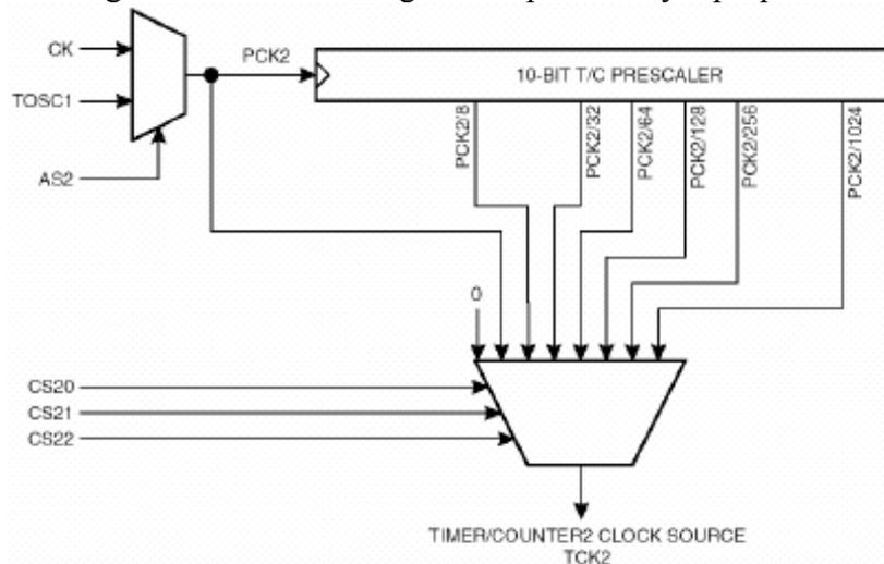
La chaîne de pré-division contenue dans le microcontrôleur permet de fournir 3 horloges :
