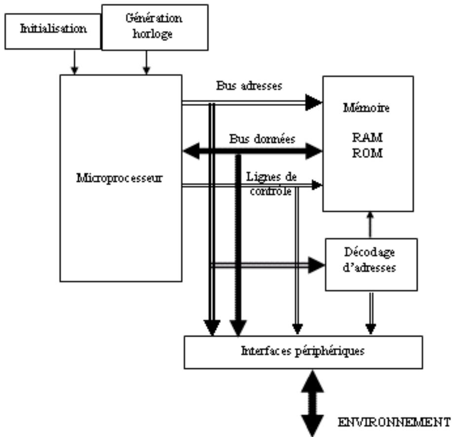
L'architecture matérielle minimum d'un système à microprocesseur est représentée sur la figure précédente. Celle-ci comporte :
