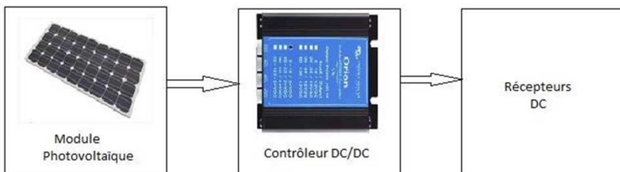
Figure II.2: représentation synoptique de la structure d'un système PV sans stockage
