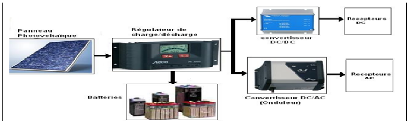
Figure II.1 : représentation synoptique de la structure d'un système photovoltaïque avec stockage
