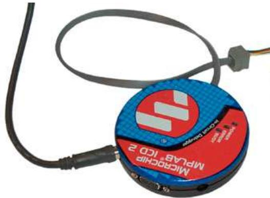
Il programme les PIC via une prise ICSP et permet le débogage d'un programme à l'aide du logiciel MPLAB que voici l'écran d'application :
