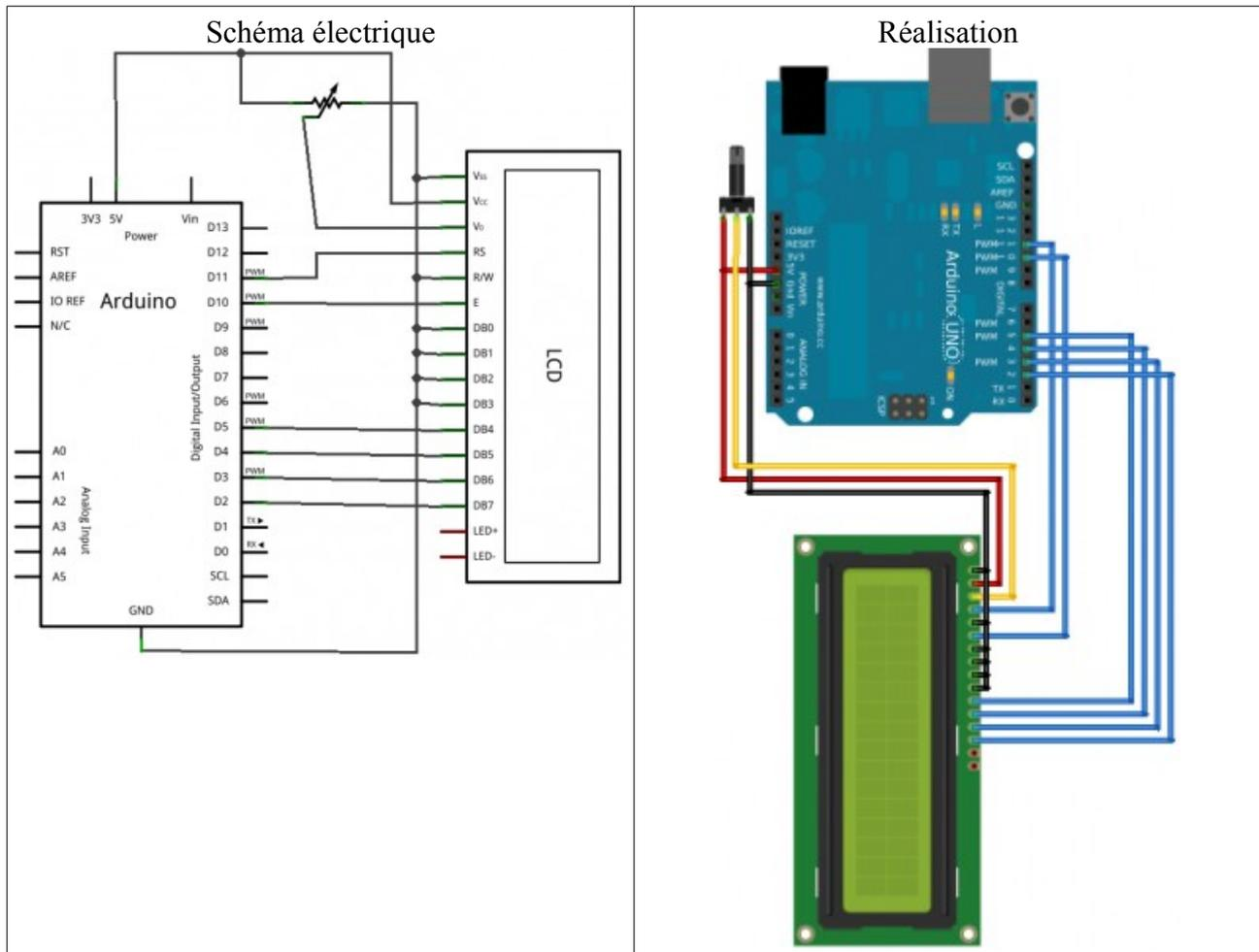
L'afficheur LCD utilise 6 à 10 broches de données ((D0 à D7) ou (D4 à D7) + RS + E) et deux d'alimentations (+5V et masse). La plupart des écrans possèdent aussi une entrée analogique pour régler le contraste des caractères. On branchera dessus un potentiomètre de 10 k $\Omega$ .
