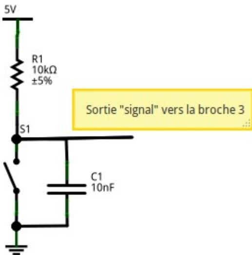
Pour atténuer ce phénomène, on utilise un condensateur en parallèle avec le bouton. Ce composant servira ici "d'amortisseur" qui absorbera les rebonds (comme sur une voiture avec les cahots de la route). Le condensateur, initialement chargé, va se décharger lors de l'appui sur le bouton. S'il y a des rebonds, ils seront encaissés par le condensateur durant cette décharge. Il se passera le phénomène inverse (charge du condensateur) lors du relâchement du bouton.
