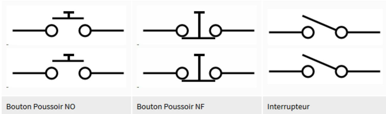
À la différence d'un bouton poussoir, l'interrupteur agit comme une bascule. Un appui ferme le circuit et il faut un second appui pour l'ouvrir de nouveau. Il possède donc deux états stables (ouvert ou fermé). On dit qu'un interrupteur est bistable.
