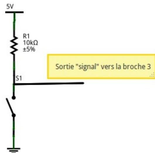
En électronique, on a toujours des perturbations (générées par des lampes à proximité, un téléphone portable, ...). On appelle ça des contraintes de CEM. Pour contrer ces effets nuisibles, on place en série avec le bouton une résistance de **pull-up**. Cette résistance sert à "tirer" ("to pull" in english) le potentiel vers le haut (up) afin d'avoir un signal clair sur la broche étudiée.
