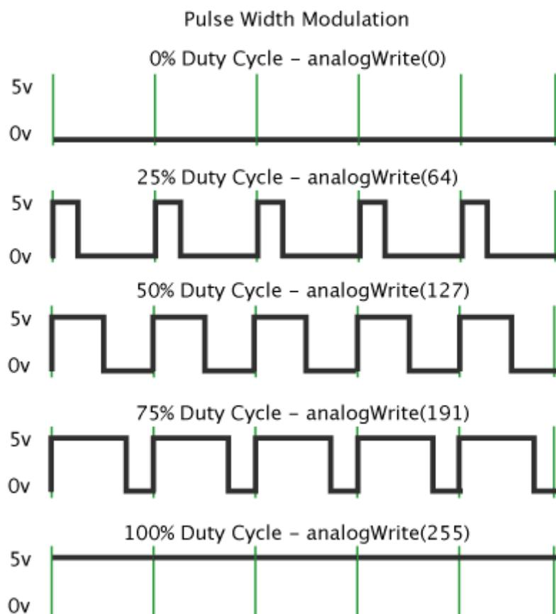
La carte Arduino dispose de 6 broches qui sont compatibles avec la génération d'une PWM. Elles
