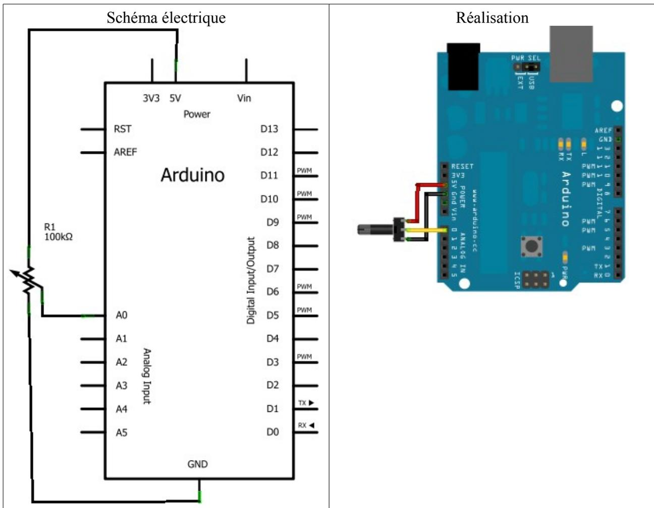
Une fois le raccordement fait, un petit programme pour va effectuer une mesure de la tension obtenue sur le potentiomètre, puis envoyer la valeur lue sur la liaison série :
