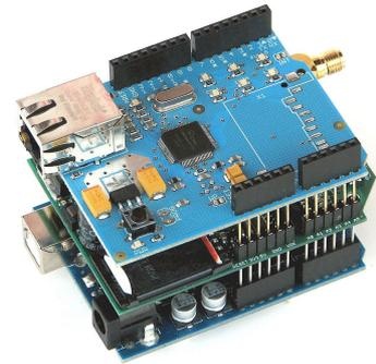
Sur les Arduino et sur beaucoup de cartes compatibles Arduino, les connecteurs se trouvent au même endroit. Cela permet de fixer des cartes d'extension, appelée *shields* en les empilant.
