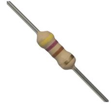
On peut alors comparer, le débit d'eau au courant électrique **I** (qui est d'ailleurs le débit d'électrons), la différence de pression à la différence de potentiel électrique (qui est la tension **U**) et, enfin, le rétrécissement à la résistance **R**.
