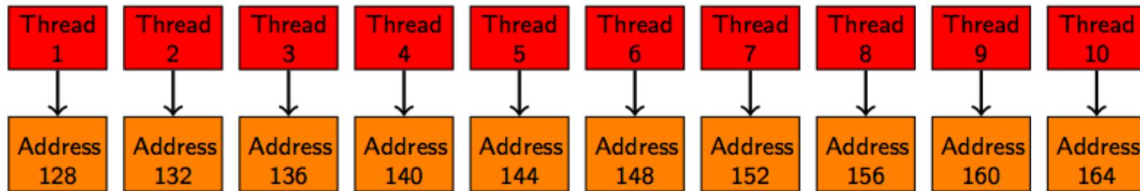
On doit accéder à la mémoire par des accès 8, 16, 32/64 128 bits consécutifs (dans l'ordre des threads pour avant 1.2 - ce n'est pas notre cas ici), dans un bloc mémoire de 32, 64 ou 128 octets; adresse de départ alignée modulo 16
