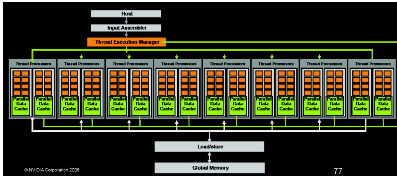
(ici 128 threads procs. pour 8 multi-procs de 16 coeurs) L'hôte peut charger des données sur le GPU, et calculer en parallèle avec le GPU
