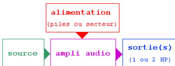
Synoptique d'un système d'amplification audio complet. Le montage amplificateur nécessite bien entendu une alimentation, soit par piles, soit par transformateur, pont redresseur et régulateur. Selon que l'ampli est mono ou stéréo, on aura en sortie 1 ou 2 haut-parleurs.
