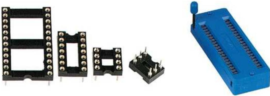
A gauche, supports "tulipe" pour c.i., et à droite, le *nec plus ultra*: un support zif (*zero insertion force*) à levier, surtout utilisé pour les microcontrôleurs, microprocesseurs, etc.
