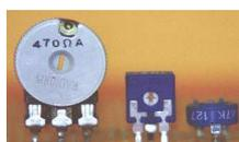
Il existe une grande variété de modèles, à piste de carbone ou à piste cermet, capotés ou non, horizontaux (pour un montage "couché") ou verticaux (montage "debout").
