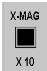
Lorsque le bouton **X-MAG** est enfoncé, l'échelle horizontale est multipliée par 10. Si par exemple TIME/DIV est réglé sur 1 ms/div, l'échelle passe 0,1 ms/div.
