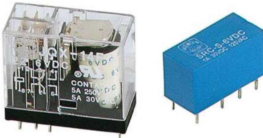
Deux modèles de relais d'usage courant. Notez les inscriptions en clair sur le capot du modèle de gauche (y compris le brochage) et sur la face supérieure du modèle de droite.
