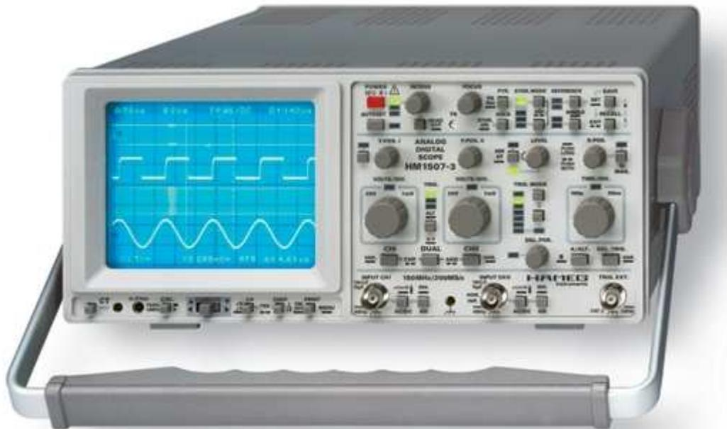
Pour visualiser et mesurer un signal électrique, ou même plusieurs signaux simultanément, on utilise un appareil appelé oscilloscope. (Document Hameg).
