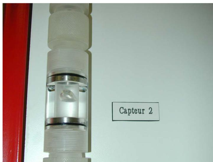
La boucle d'essais est constituée d'une colonne en PVC de longueur 75 cm et de diamètre interne 14 mm. Deux sondes identiques à celle décrite ci-dessus sont ajoutées en série à l'extrémité supérieure du tube. Leur longueur totale est 27 cm.
