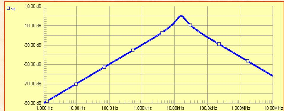
Un filtre est caractérisé par la valeur de la fréquence à laquelle il transmet "un maximum",  $\omega_0$ , mais aussi par sa largeur (bande passante). Par définition on choisit de mesurer la largeur lorsque l'amplitude est égale à  $1/\sqrt{2}$  fois l'intensité du maximum (Gain = -3dB).
